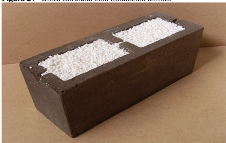
Figura 24 - Bloco estrutural com isolamento térmico
