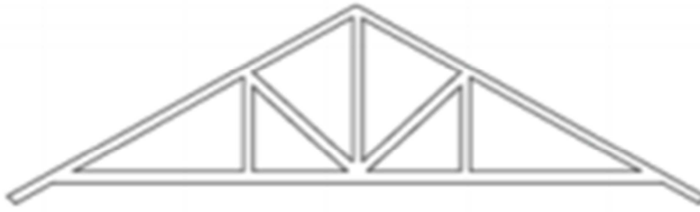
Figura 9 - Tesoura do tipo howe utilizada para os dois métodos construtivos
