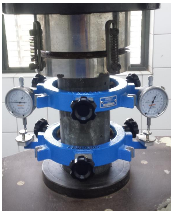
Figura 18 - Ensaio do módulo de elasticidade
