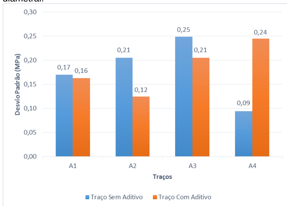
Figura 34 - Desvio padrão do ensaio de resistência à tração por compressão diametral.
