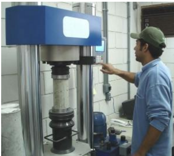
Figura 16 - Ensaio de compressão axial no concreto
