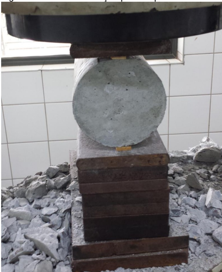
Figura 31 - Ensaio de tração por compressão diametral
