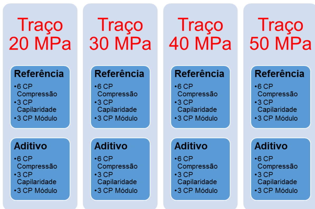
Figura 12 - Esquema para moldagem de corpos de prova
