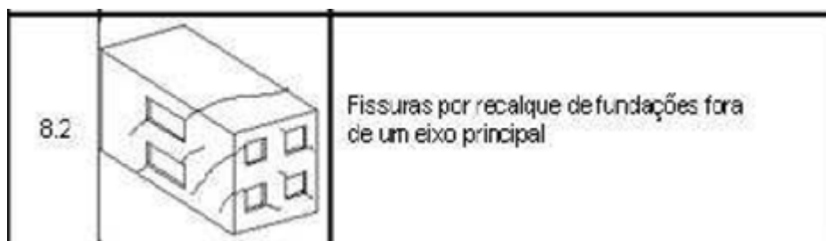
Figura 28 – Fissuras causadas por recalques. Fonte: TAGUCHI apud KLIMPEL E SANTOS, 2010.
