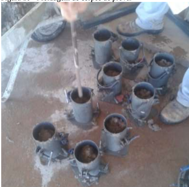
Figura 10 - Moldagem de corpos de prova.
