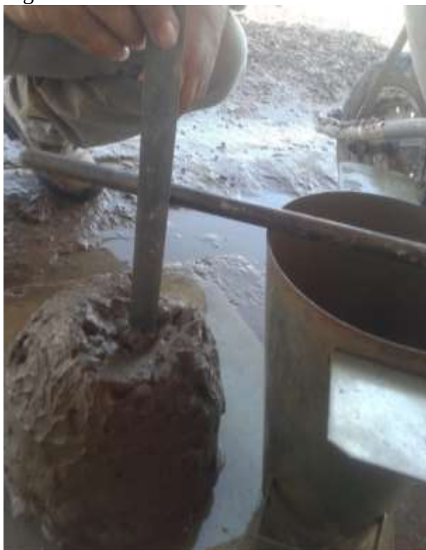
Figura 6 - Ensaio de abatimento do tronco de cone.
