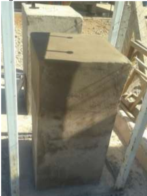
Figura 17 - Pilar concreto autoadensável.
