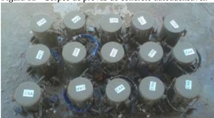
Figura 11 - Corpos de provas de concreto autoadensável.
