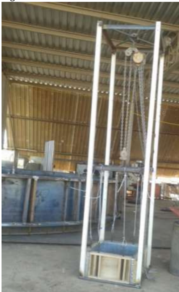
Figura 14 - Modelo reduzido de fôrma deslizante.
