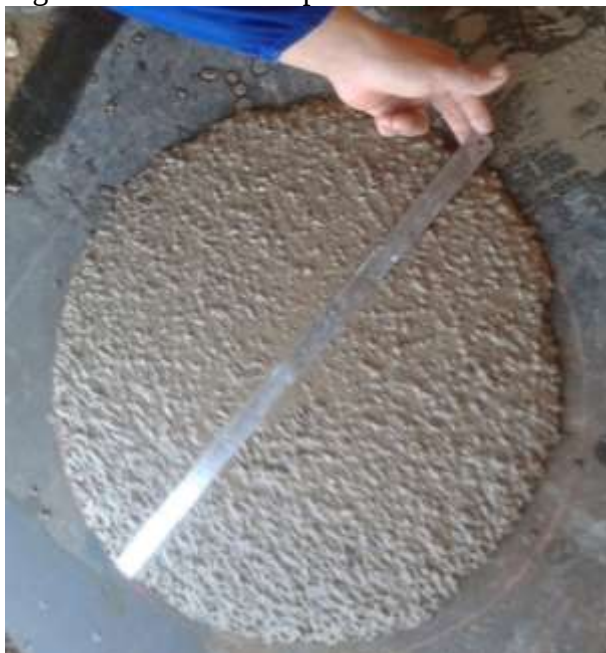
Figura 7 - Ensaio Slump Flow.
