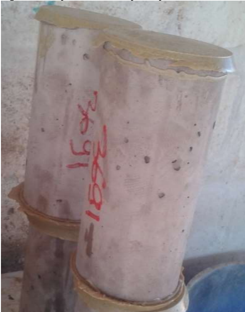
Figura 12 - Capeamento dos corpos de provas.
