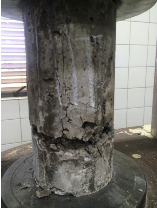
Figura 33 – corpo de prova do traço 4 sendo rompido
