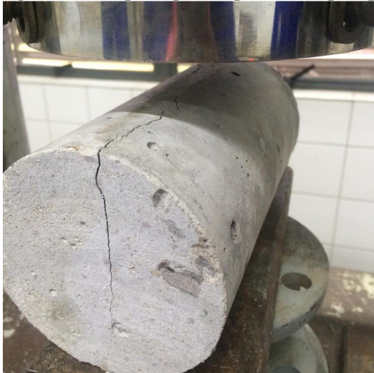
Figura 38 - Corpo de prova após ser rompido por tração
