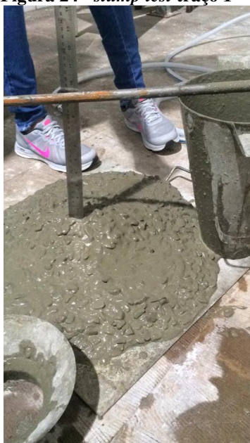
Figura 24 - slump test traço 1
