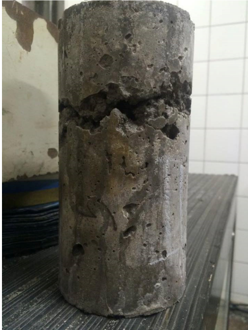
Figura 37 - corpo de prova com bastante vazios
