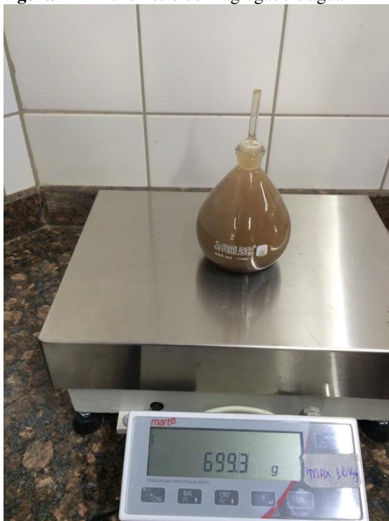
Figura 11 - Picnometro com agregado e água
