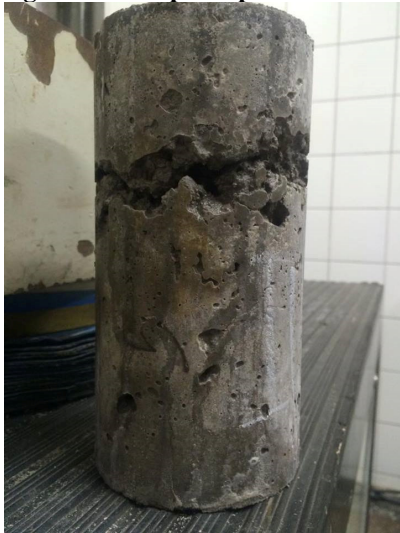
Figura 31 - corpo de prova com alto nível de vazios
