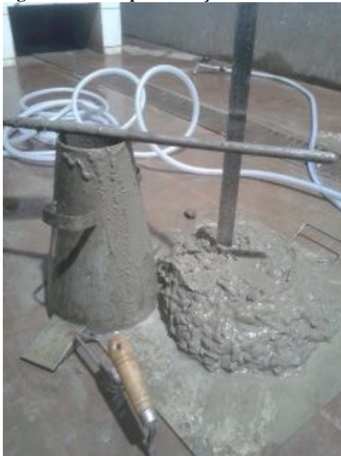
Figura 26 - slump test traço 3
