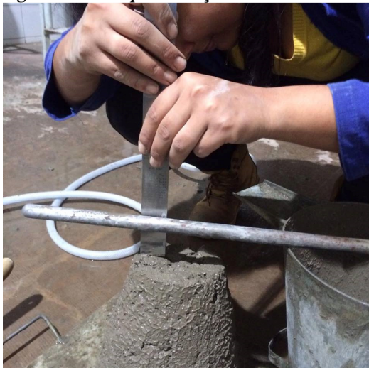
Figura 28 - slump test traço 5
