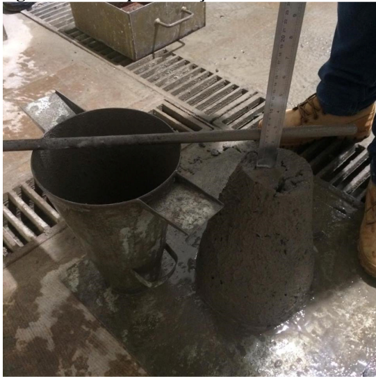
Figura 27 - slump test traço 4
