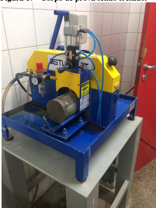
Figura 17 - Corpo de prova sendo fresado.
