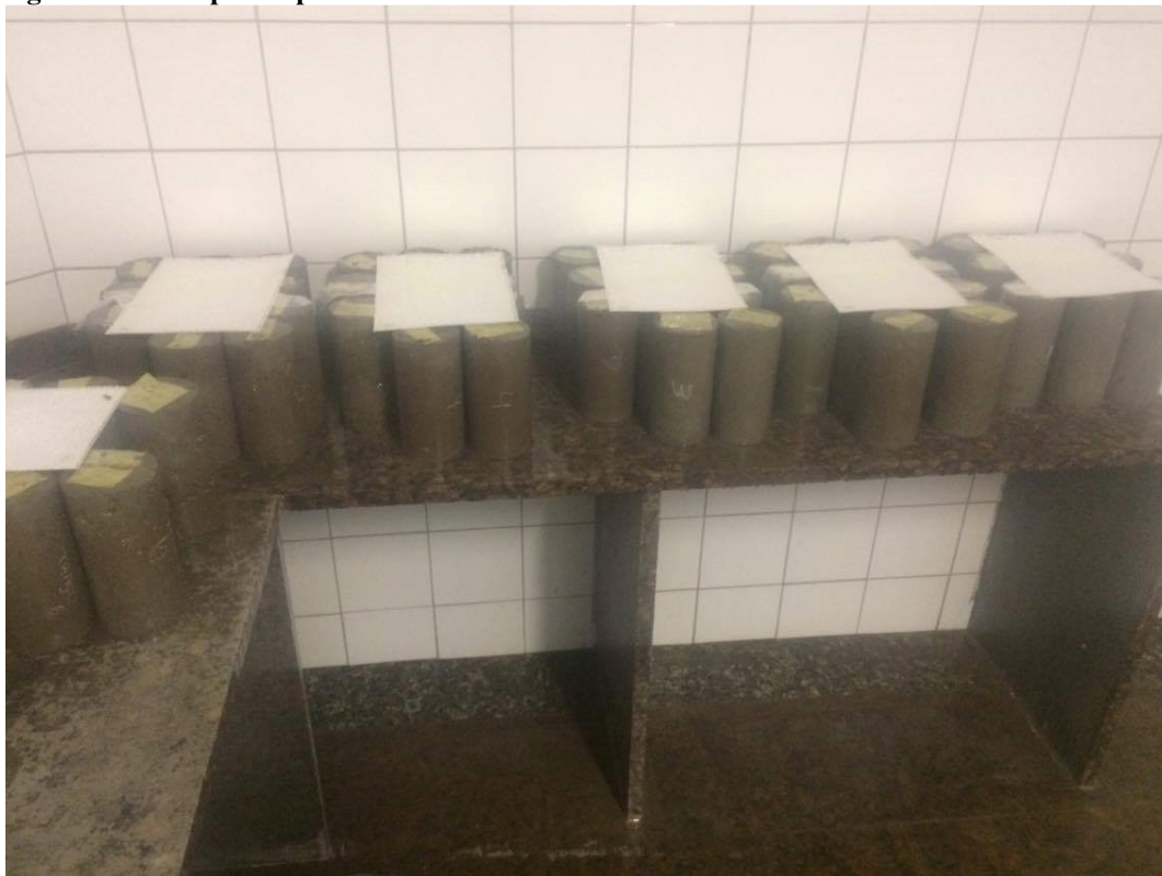
Figura 155 - Corpos de prova desmoldados e identificados armazenados em câmara úmida.
