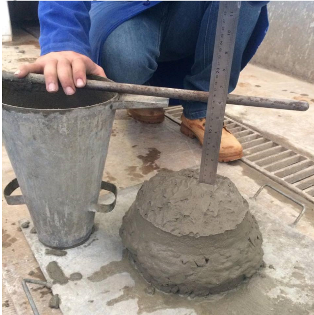
Figura 25 - slump test traço 2
