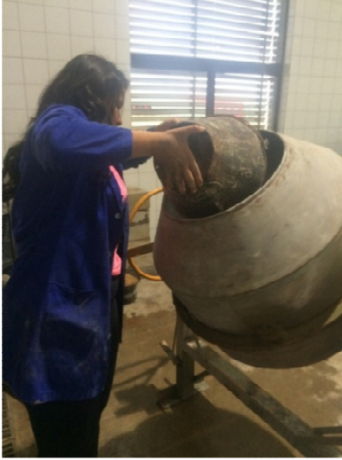
Figura 12 - Materiais sendo inseridos na betoneira
