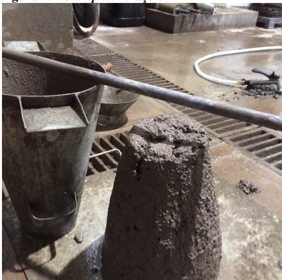
Figura 29 - slump test traço 6
