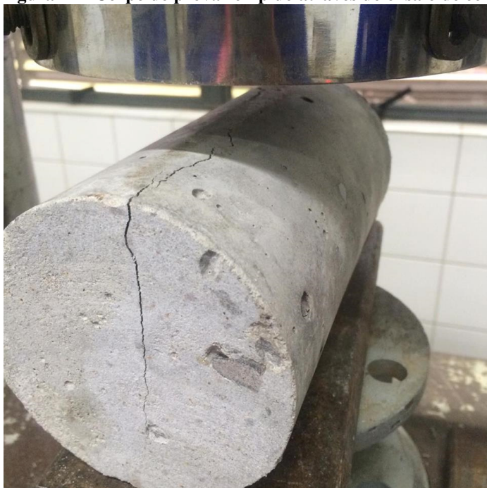
Figura 21 - Corpo de prova rompido através do ensaio de compressão por tração diametral
