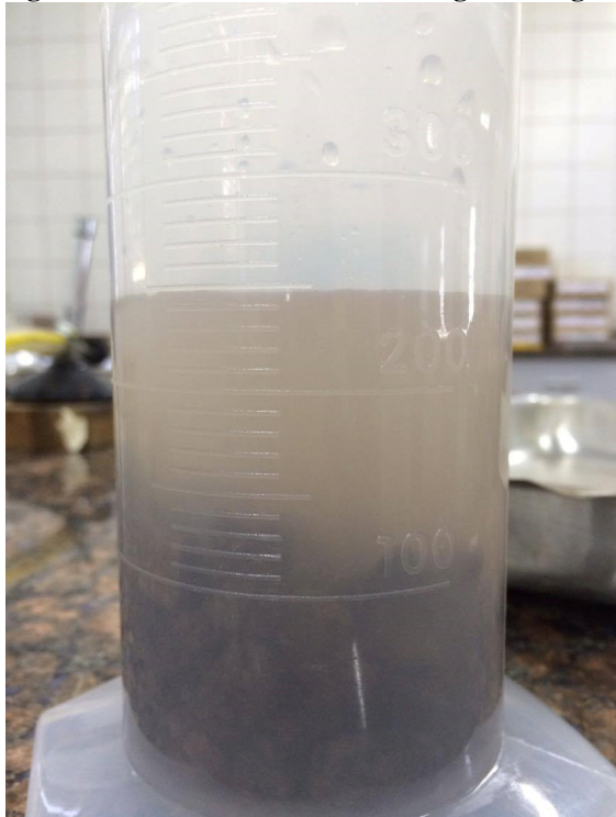
Figura 10 - Proveta com 200 ml de água e 150g de agregado graúdo
