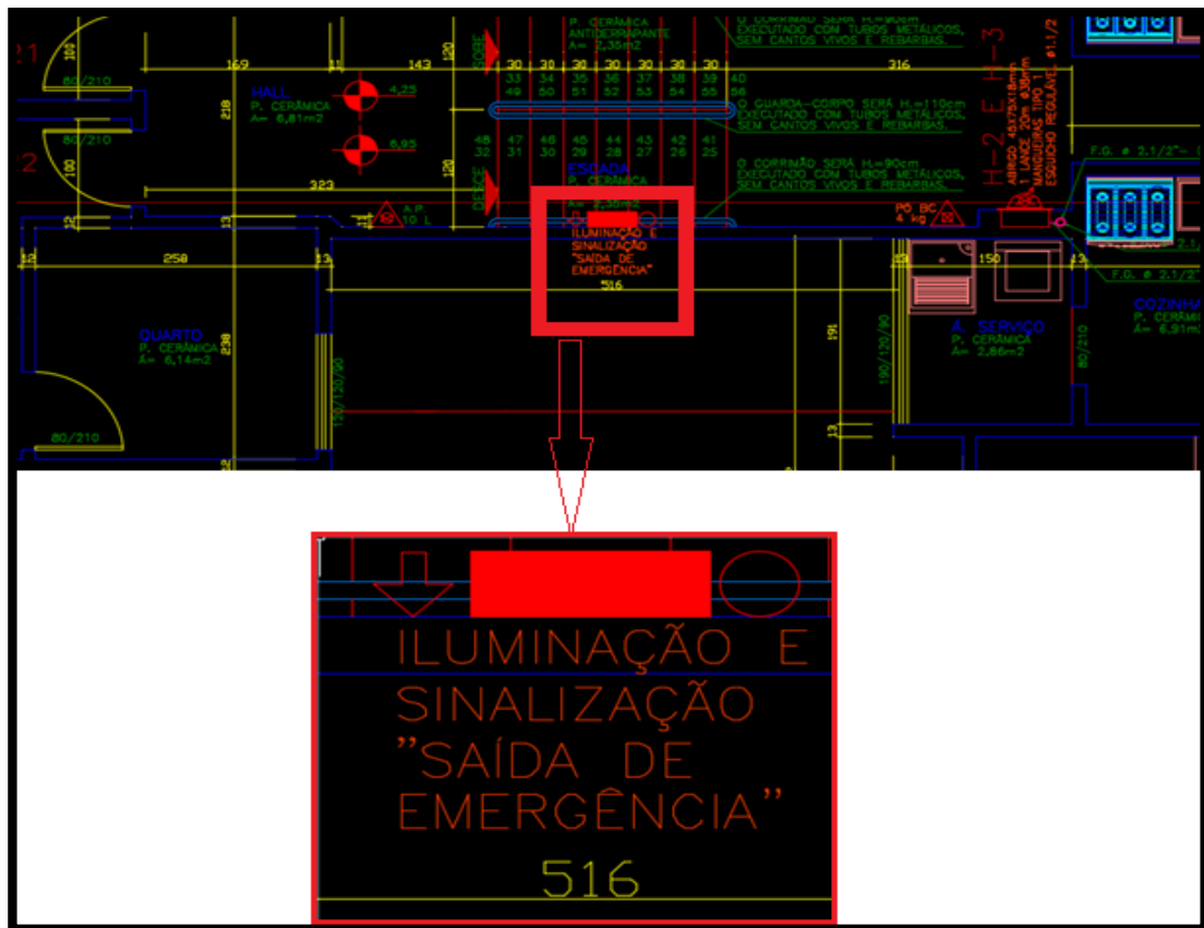
Figura 39: Detalhe planta baixa – Iluminação de emergência.
