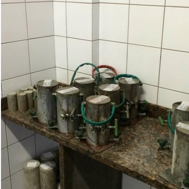
Figura 12: Armazenamento dos corpos de prova.
