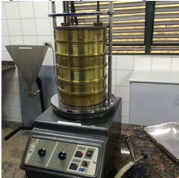
Figura 5: Conjunto de peneiras sobre o agitador mecânico.
