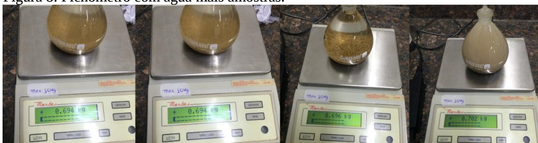
Figura 8: Picnômetro com água mais amostras.
