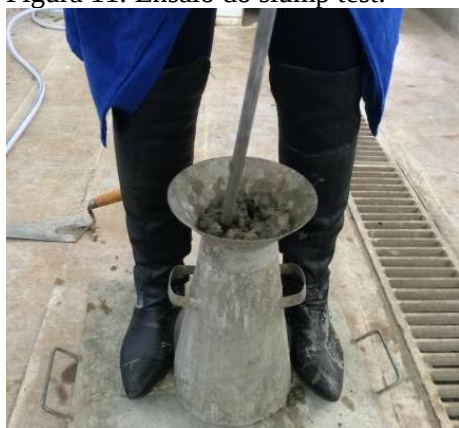
Figura 11: Ensaio do slump test.
