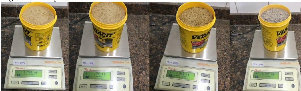
Figura 10: Recipiente da massa unitária com as amostras.
