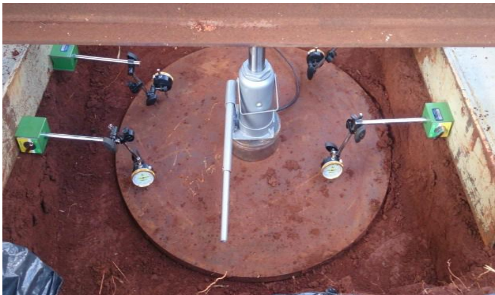
Figura 10 – Placa metálica, célula de carga, macaco hidráulico e extensômetros
