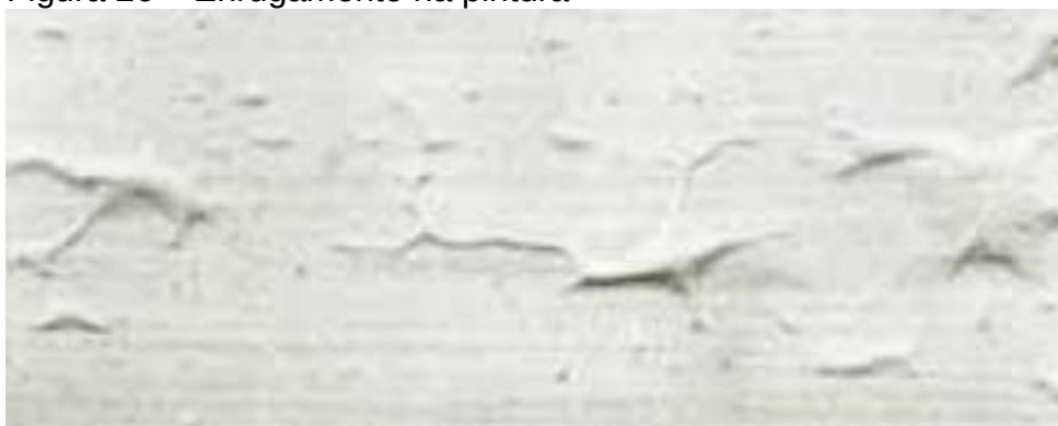
Figura 26 – Enrugamento na pintura
