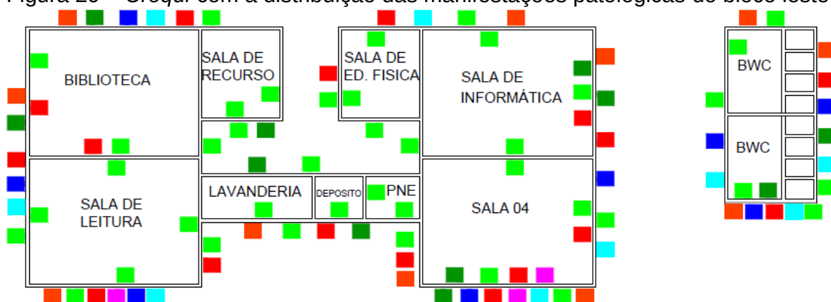
Figura 29 – Croqui com a distribuição das manifestações patológicas do bloco leste
