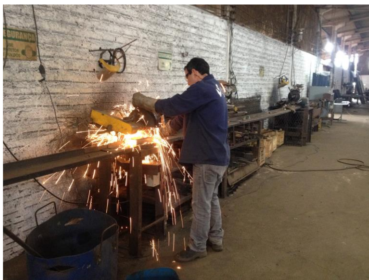
Figura 05: Funcionário efetuando um corte com o auxílio do policorte.
