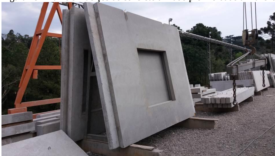
Figura 28 – Painéis maciços de concreto armado pré-moldado armazenados.
