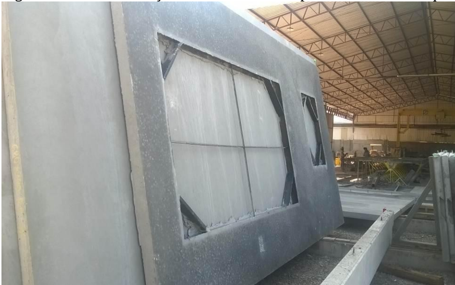
Figura 21 – Pannel maciço de concreto armado pré-moldado no estoque da fábrica.
