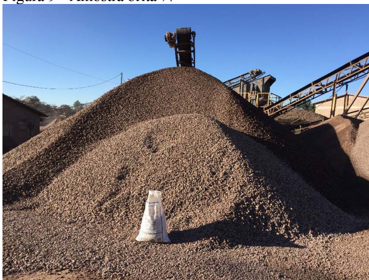
Figura 9 - Amostra brita \frac{3}{4} "
