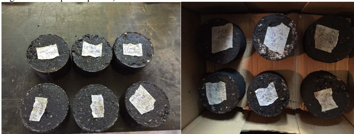
Figura 29 - Corpos de provas, CAP 50/70 e CAP SBS 65/90
