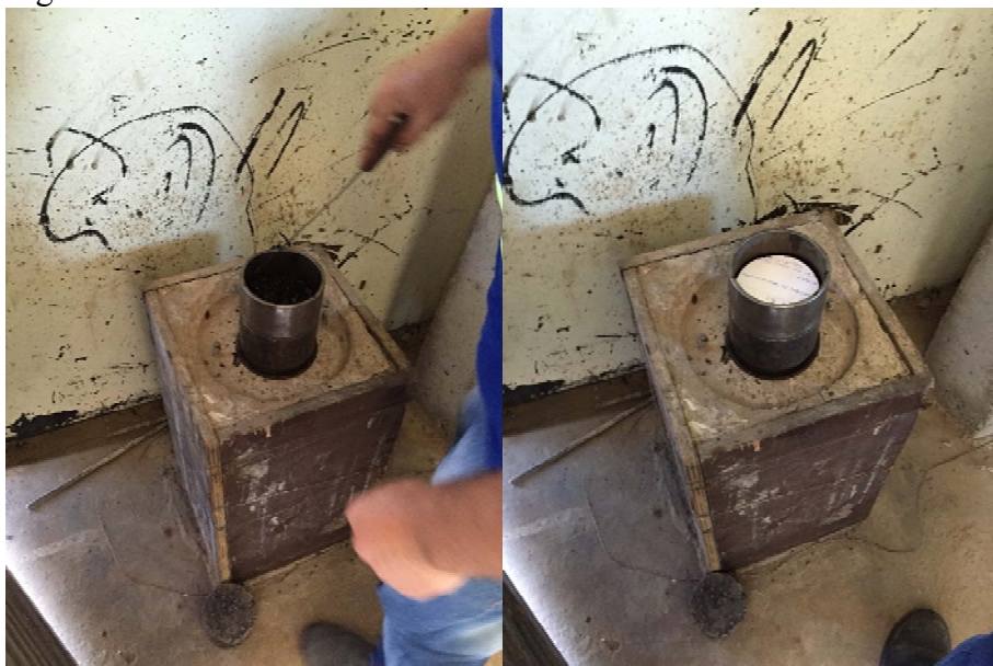
Figura 25 – Amostra nivelada no molde
