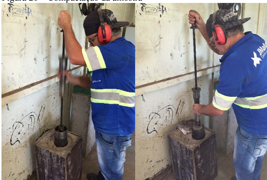
Figura 26 – Compactação da amostra
