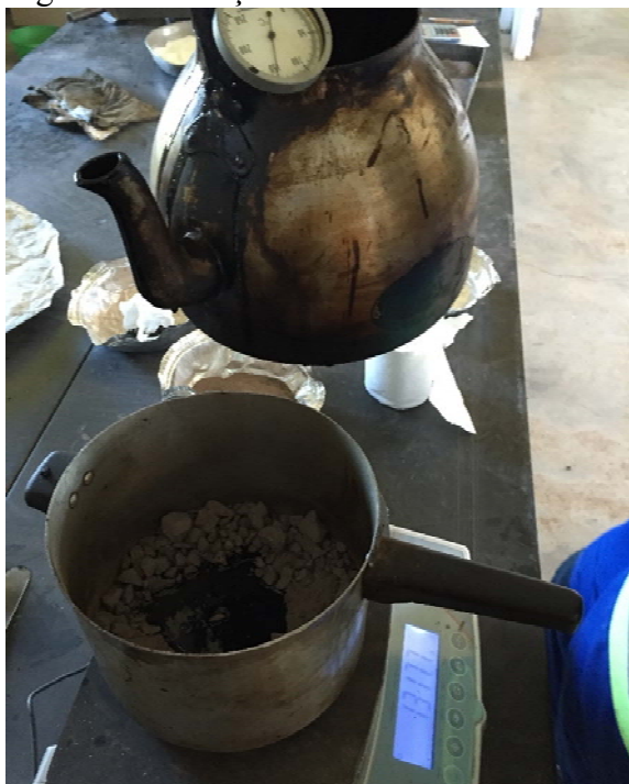
Figura 19 – Adição CAP 50/70 na mistura
