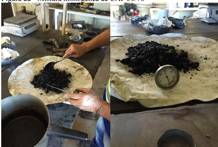
Figura 22 - Mistura homogênea de CAP 50/70
