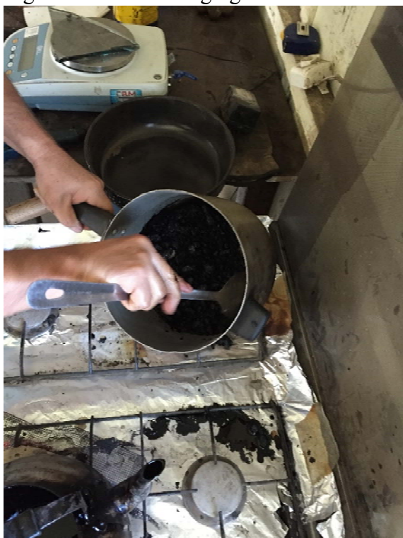
Figura 21 – Mistura agregado com o CAP
