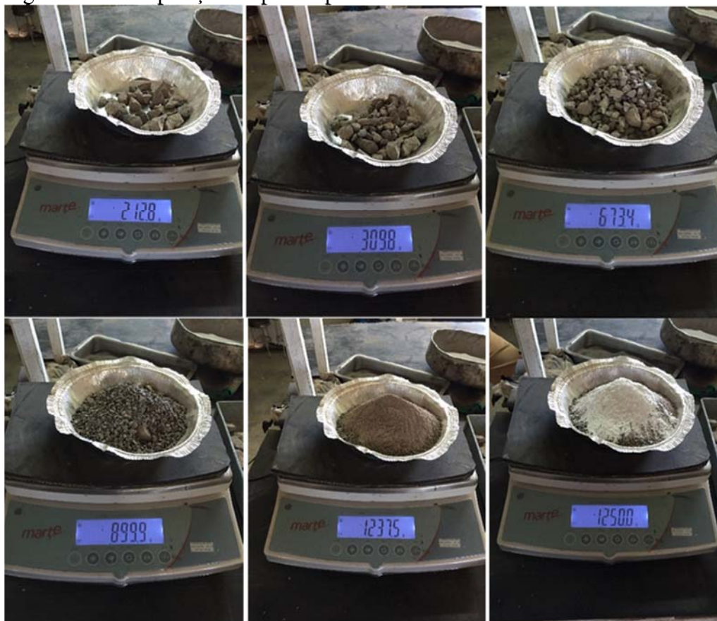
Figura 14 – Composição corpos de provas CAP 50/70
