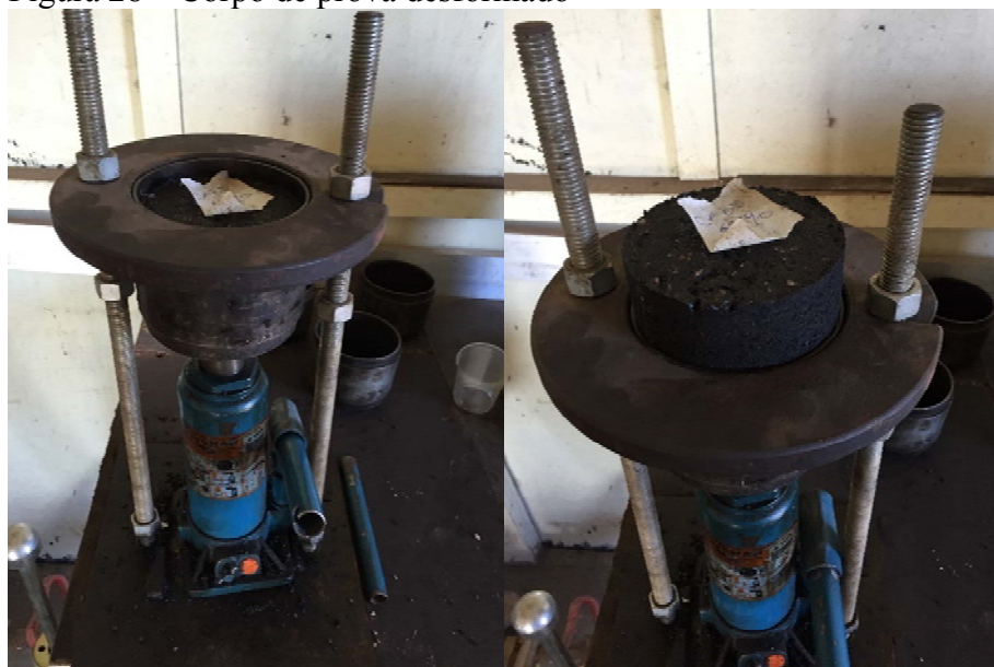
Figura 28 – Corpo de prova deformado
