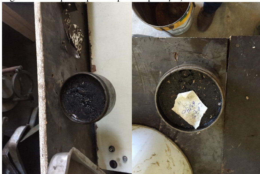
Figura 27 – Corpos de provas após compactação, CAP 50/70 e CAP SBS 65/90
