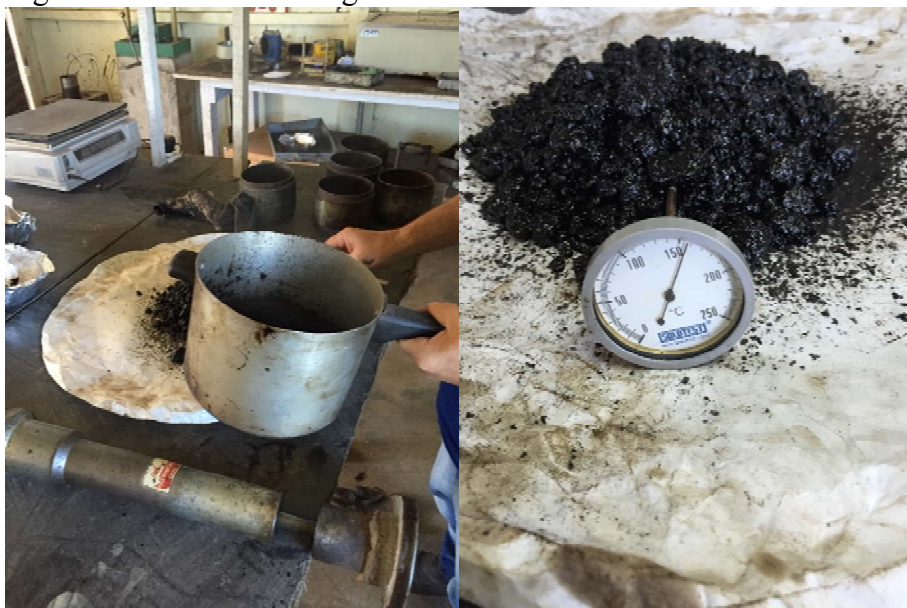
Figura 23 – Mistura homogênea de CAP SBS 65/90
