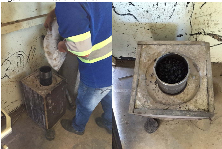
Figura 24 – Amostra no molde
