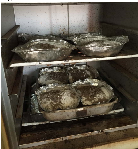
Figura 16 - Amostras na estufa
