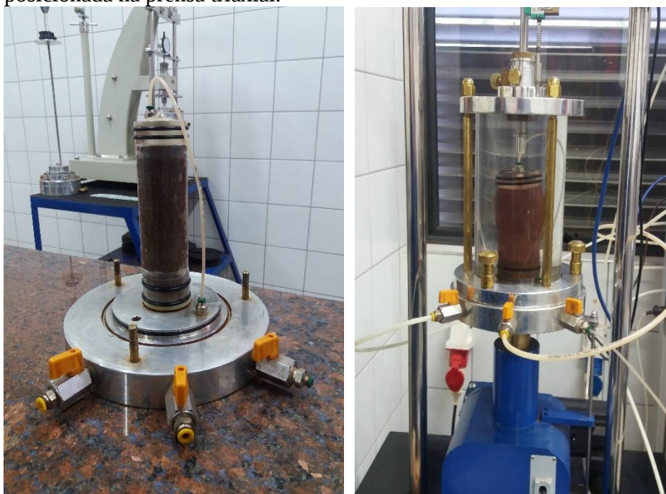
Figura 18: Corpo de prova pronto para ensaio e câmara de compressão posicionada na prensa triaxial.
