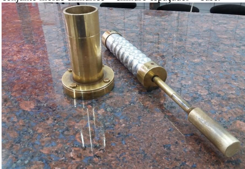
Figura 13: Equipamento “Harvard miniatura” + sapata \frac{3}{4} ” e conjunto molde cilíndrico + cilindro espaçador + base.
