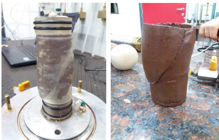
Figura 19: Corpo de prova após ruptura.
