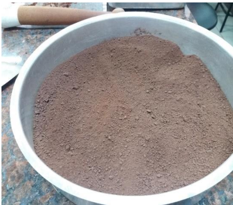
Figura 14: Amostra de solo seco com adição de cinza de casca de arroz.
