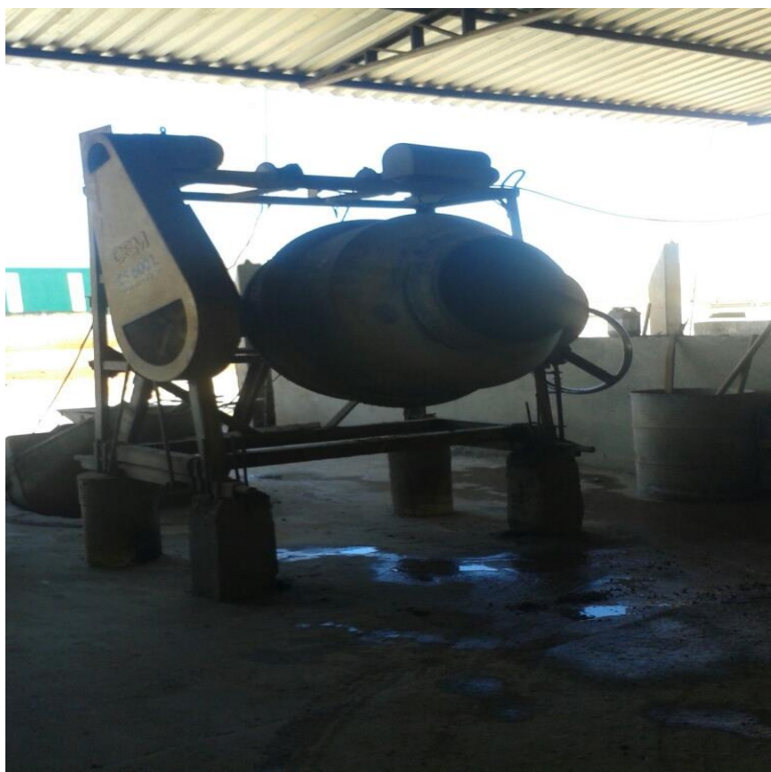
Figura 9 – Betoneira utilizada para a confecção do concreto
