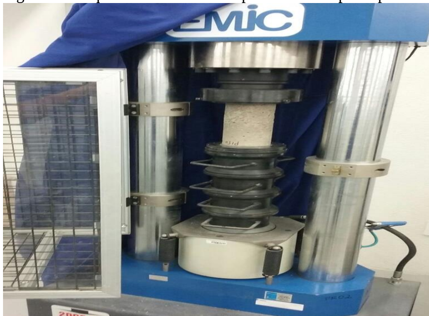
Figura 6 - Máquina de ensaio de rompimento de corpo de prova
