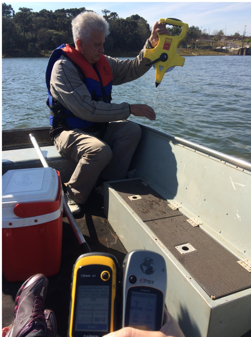
Figura 15 - Coleta de dados utilizando trena e GPS.
