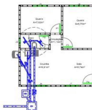
PLANTA BAIXA - ESGOTO ESC. 1/50
