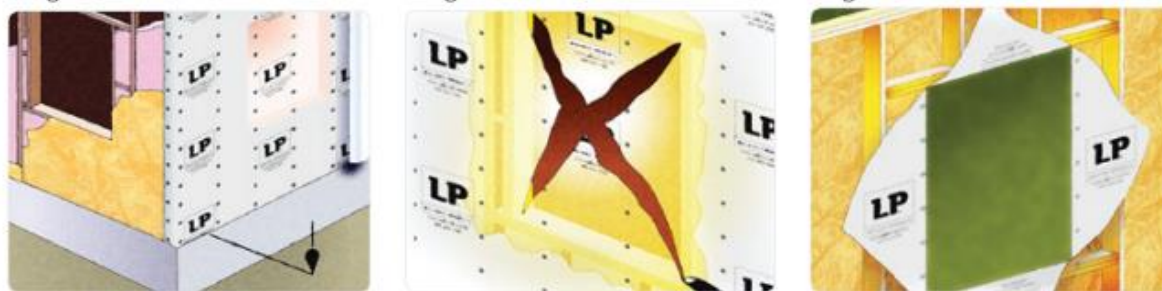
Figura 5: Membrana para impermeabilização das esquadrias.
