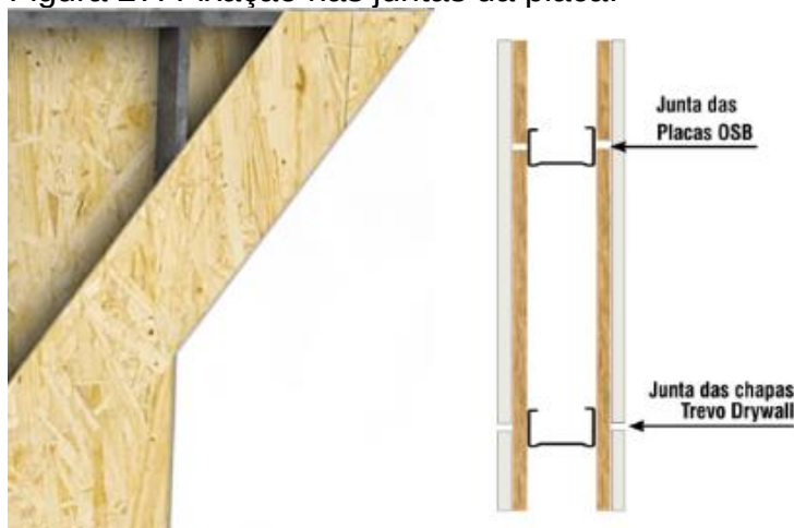
Figura 27: Fixação nas juntas da placa.
