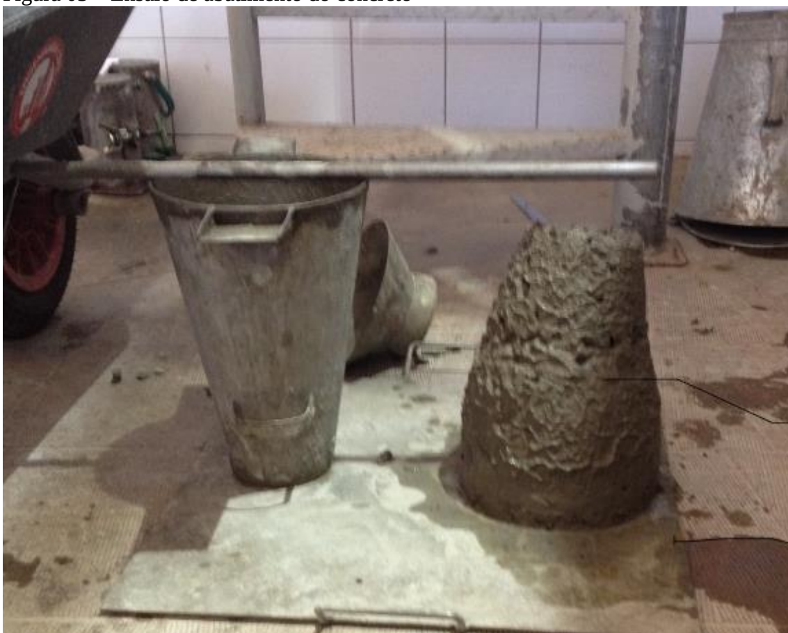
Figura 03 – Ensaio de abatimento do concreto
