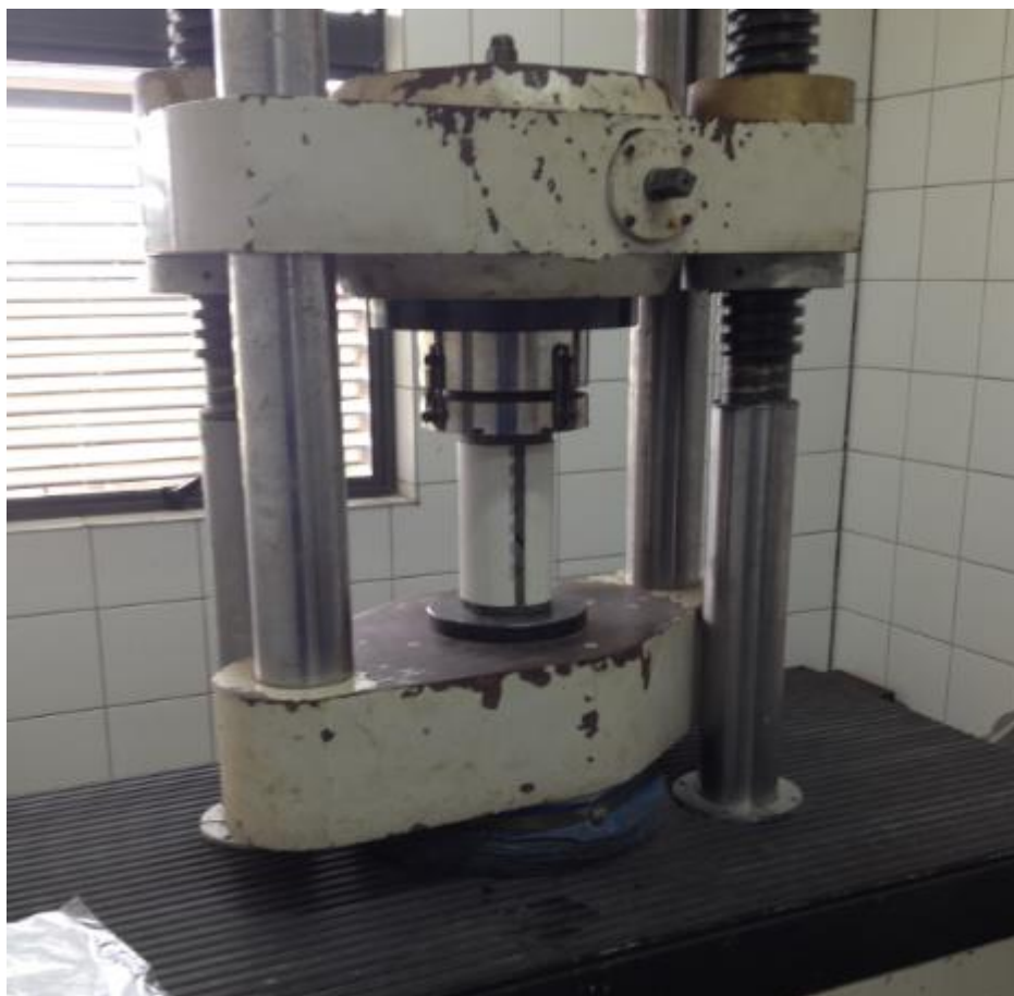
Figura 08 – Ensaio de resistência à compressão
