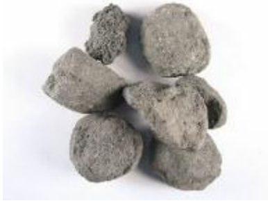
Figura 01 – Pedras de clínquer utilizadas na produção do cimento.
