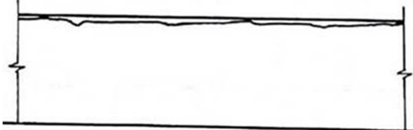
Figura 6 - Destacamento de argamassa no topo do muro.
