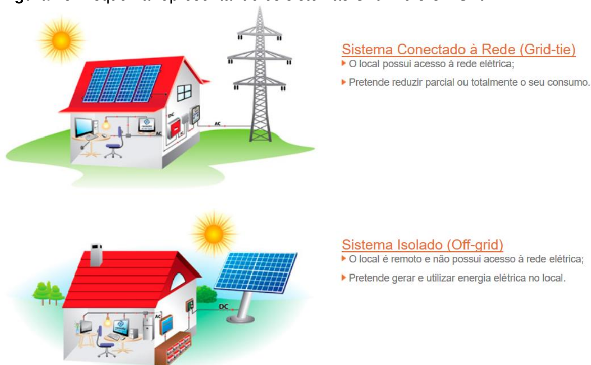
Figura 13: Esquema representando os sistemas Grid-Tie e Off-Grid .
