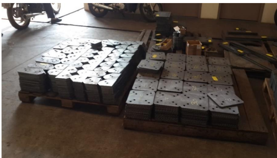
Figura 30 - Chapas cortadas e furadas
