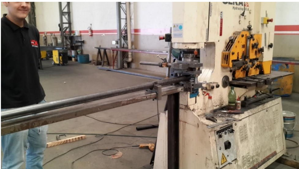
Figura 33 - Tubo colocado sobre a “mesa” para furação
