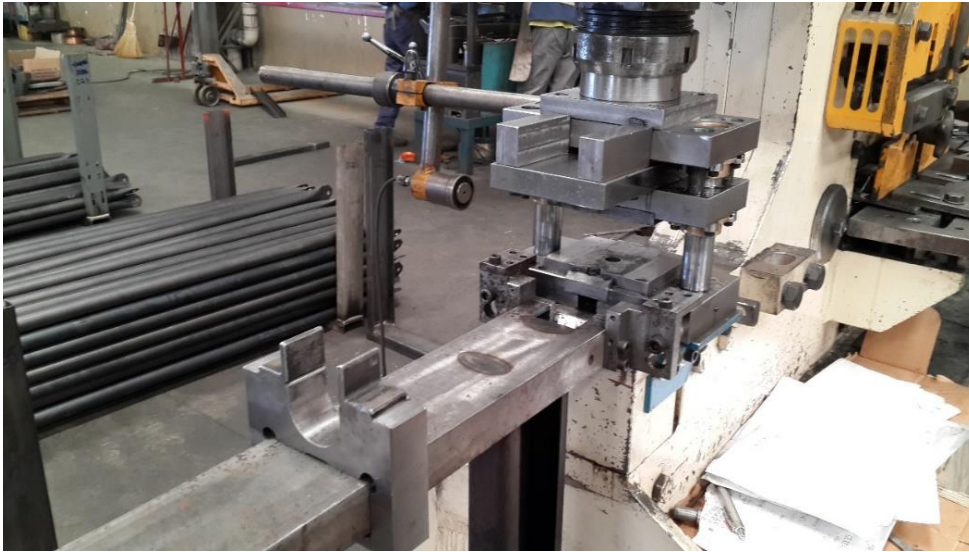
Figura 32 - Matriz para amassar e furar os tubos
