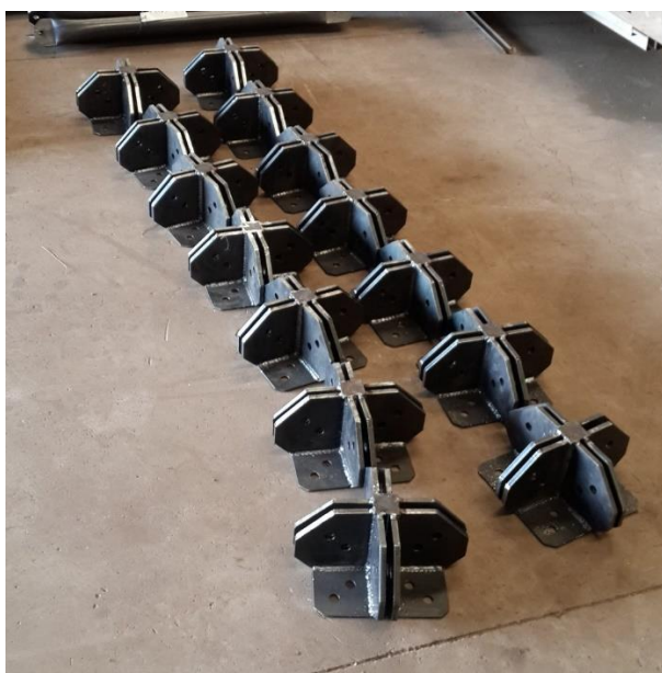
Figura 35 - Soldagem dos "nós"
