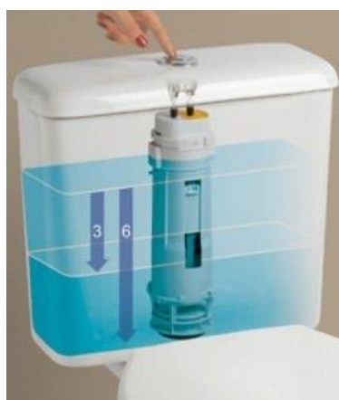
Figura 4: Modelo de funcionamento de uma bacia sanitária de acionamento duplo.
