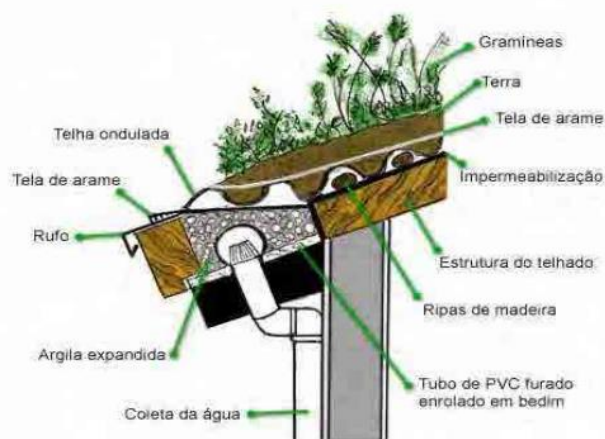
Figura 8: Detalhamento arquitetônico do sistema de cobertura verde inclinada.
