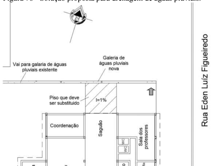
Figura 78 - Solução proposta para drenagem de águas pluviais.
