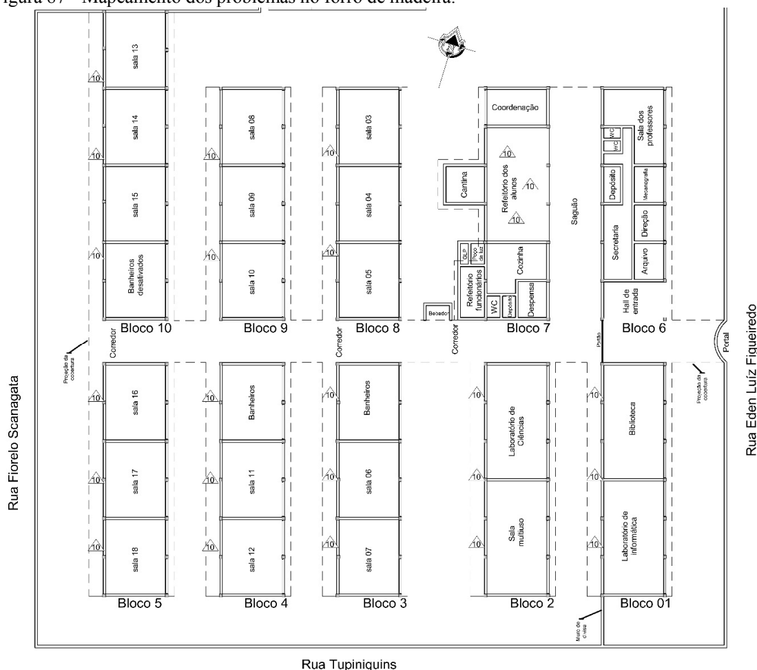
Figura 87 - Mapeamento dos problemas no forro de madeira.
