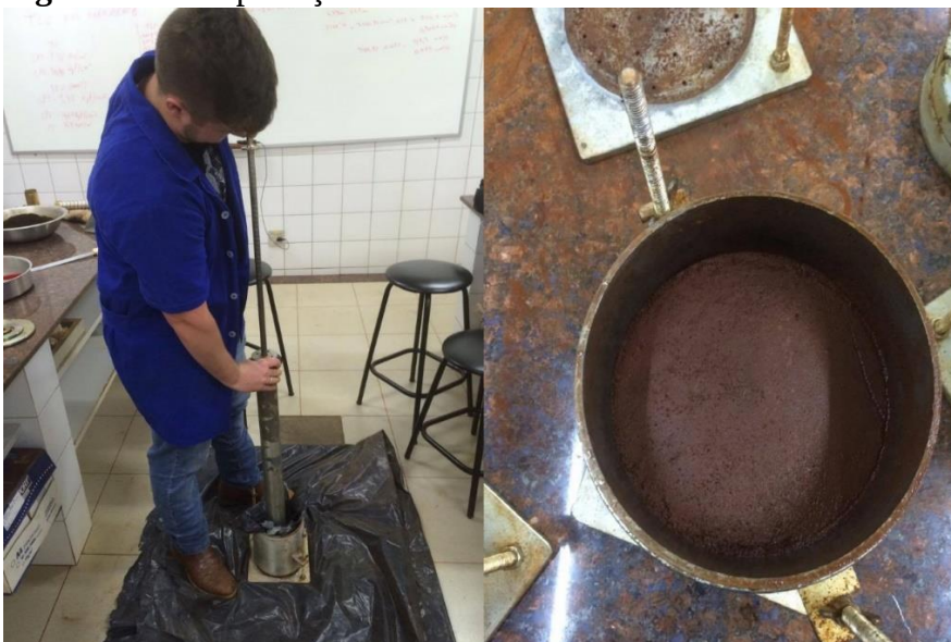
Figura 10: Compactação da amostra.
