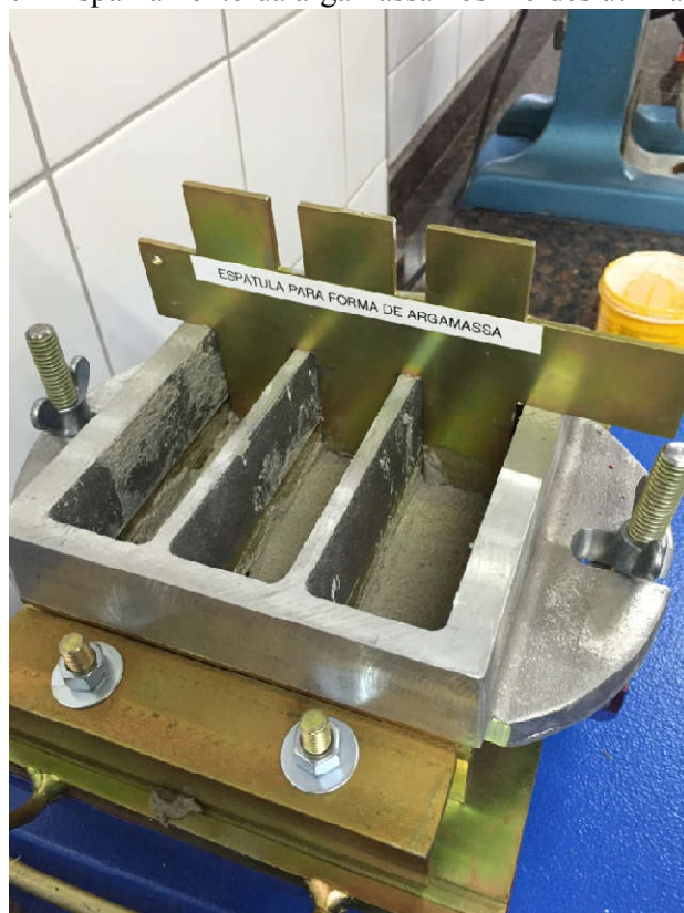
Figura 20 – Espalhamento da argamassa nos moldes utilizando a espátula.
