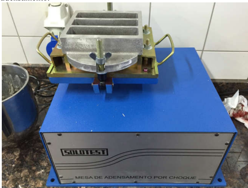
Figura 19 – Moldes prismáticos para realização dos corpos de prova, presos à mesa de adensamento.
