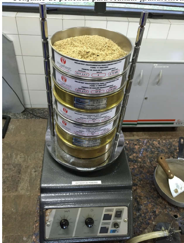
Figura 7 – Conjunto de peneiras para realizar granulometria do pó de serra.
