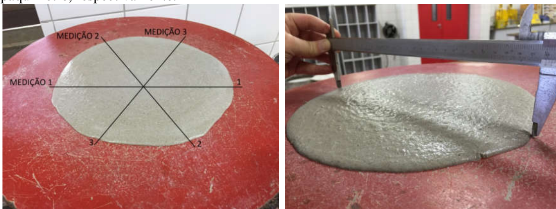
Figuras 17 e 18 – Modelo para execução das medições e realização da medição utilizando o paquímetro, respectivamente.
