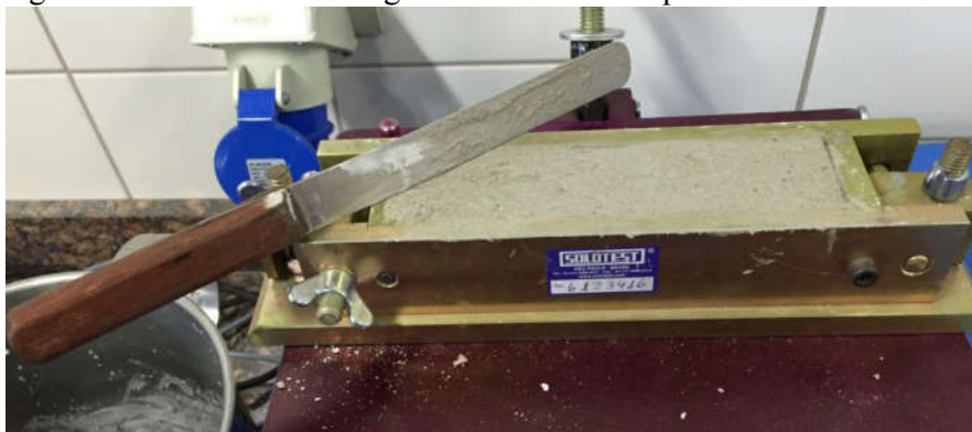
Figura 21 – Rasamento da argamassa nos moldes prismáticos.
