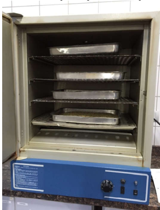
Figura 6 – Pó de serra pronto para iniciar o processo de secagem.
