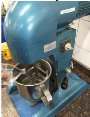
Figuras 12 e 13 – Água e aditivo, respectivamente, sendo colocados na argamassadeira.
