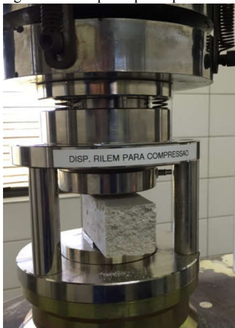
Figura 25 – Corpo de prova posicionado para teste de compressão axial.
