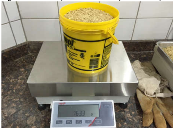
Figura 8 – Balde preenchido com pó de serra para determinação da massa unitária.
