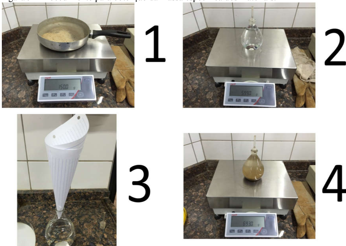
Figura 9 – Procedimento para obtenção da massa específica dos materiais.
