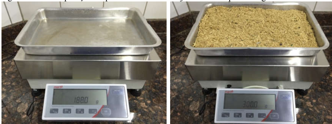
Figuras 4 e 5 – Separação do pó de serra em bandejas metálicas para secagem em estufa.
