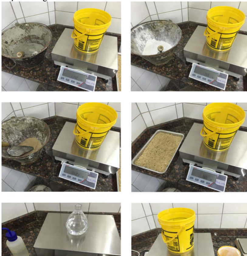
Figura 10 – Separação e pesagem individual dos materiais para a confecção de cada um dos traços de argamassa.
