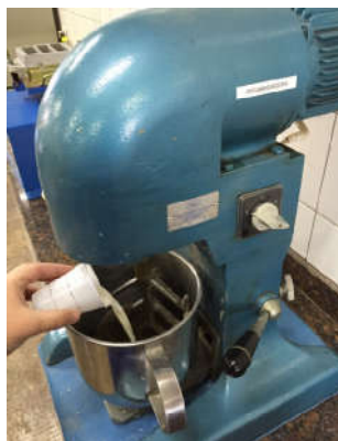
Figuras 12 e 13 – Água e aditivo, respectivamente, sendo colocados na argamassadeira.
