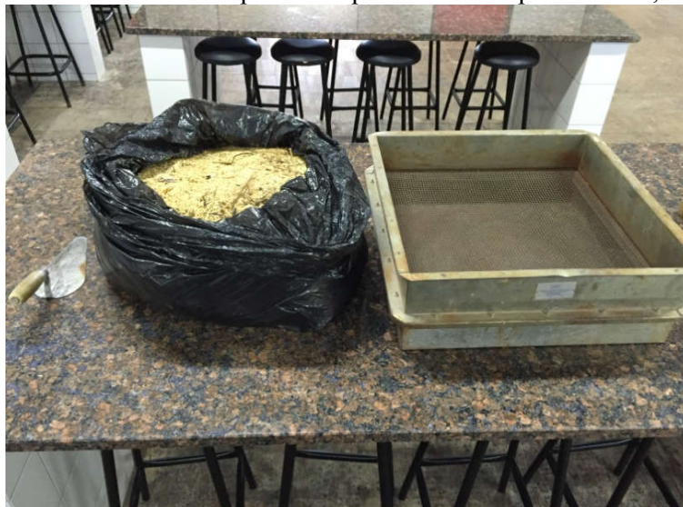
Figura 3 – Peneiramento prévio do pó de serra em peneira de 4,8mm.
