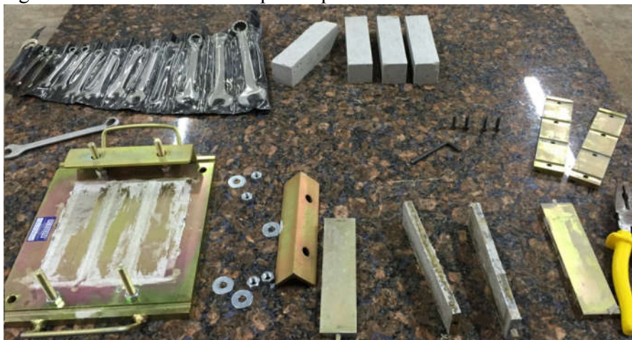
Figura 22 – Desmolde dos corpos de prova.
