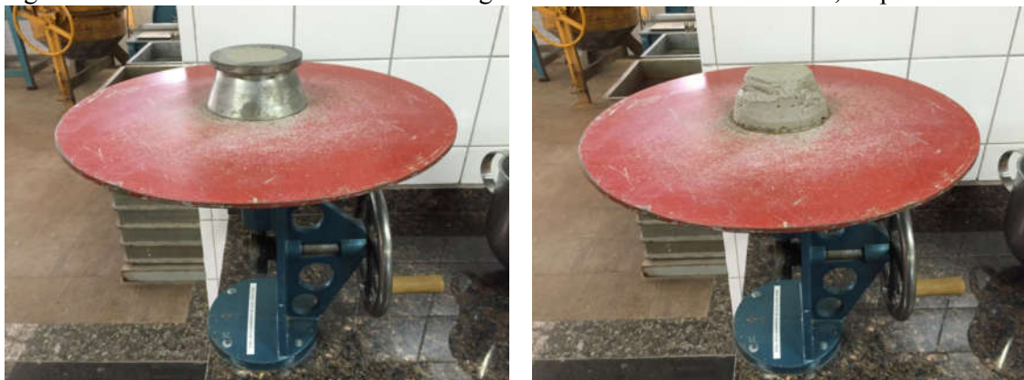
Figuras 15 e 16 – Retirada do excesso de argamassa no molde e sua retirada, respectivamente.
