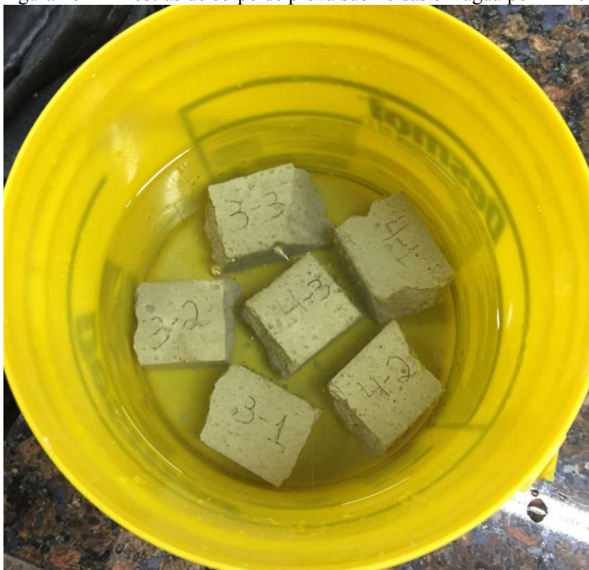
Figura 26 – Amostras de corpo de prova submersas em água por 24 horas.
