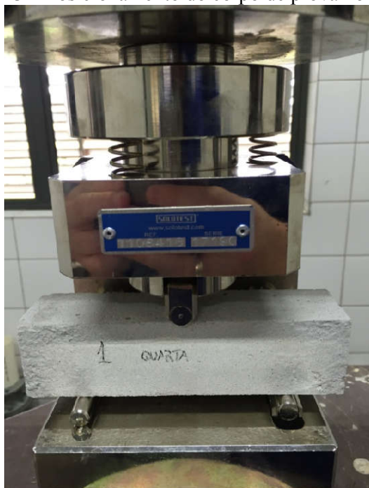
Figura 23 – Posicionamento do corpo de prova no aparato de teste à tração na flexão.
