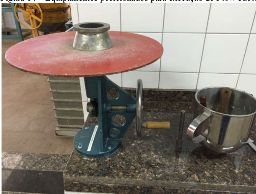
Figura 14 – Equipamentos posicionados para execução do Flow Table Test .
