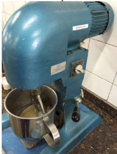
Figura 11 – Materiais posicionados na argamassadeira para dar início à mistura.
