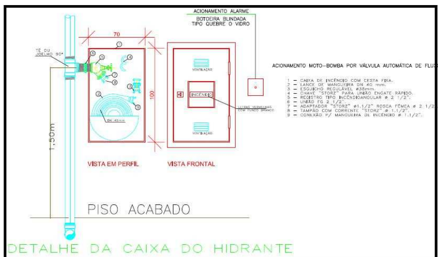
Figura 25 - Detalhe da caixa de hidrante
