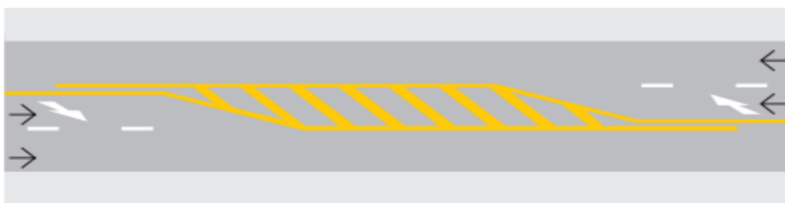
Figura 2- Marcas de canalização
