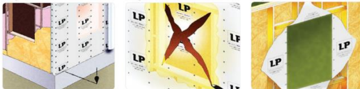
Figura 5: Membrana para impermeabilização das esquadrias.
