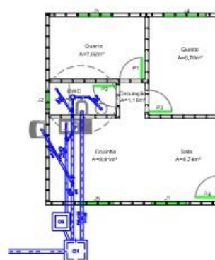
PLANTA BAIXA - ESGOTO ESC. 1/50
