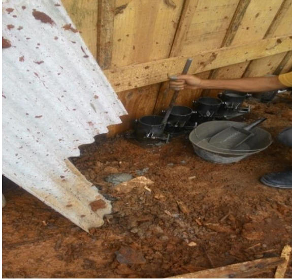
Figura 29 - Moldagem dos corpos-de-prova.
