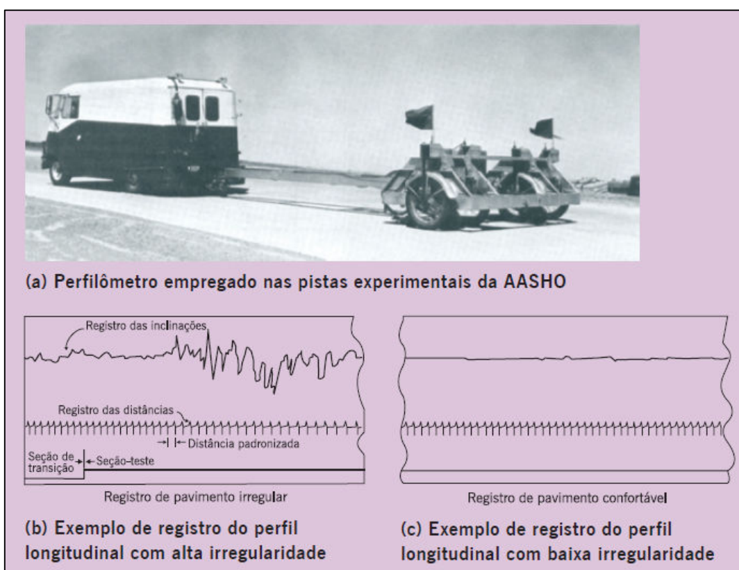
Figura 10: Perfilômetro da AASHO empregado inicialmente na avaliação do pavimento nos trechos experimentais
