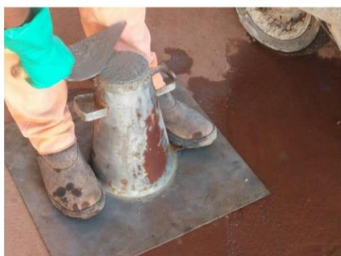
Remoção do material excedente.
