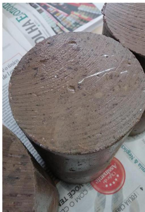
Detalhe da fibra de aço após o processo de retifica
