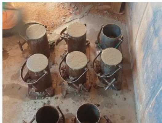
Corpos de prova moldados.
