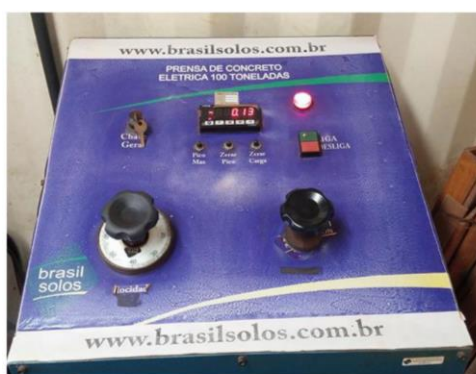
Quadro de comando da prensa hidráulica.
