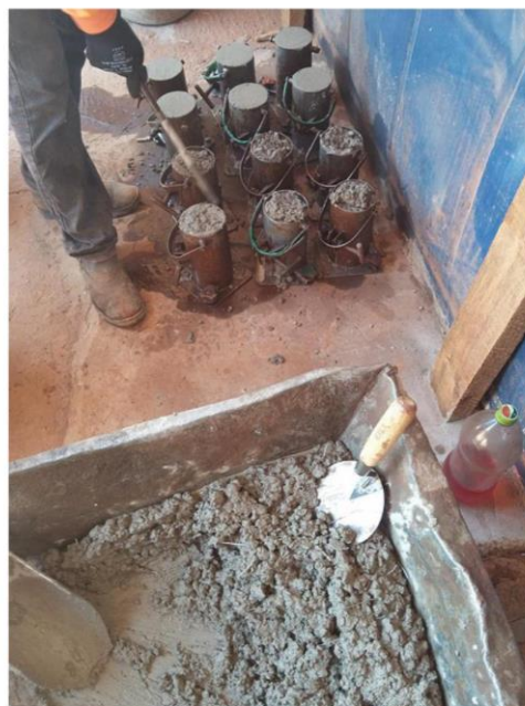
Moldagem dos corpos de prova.
