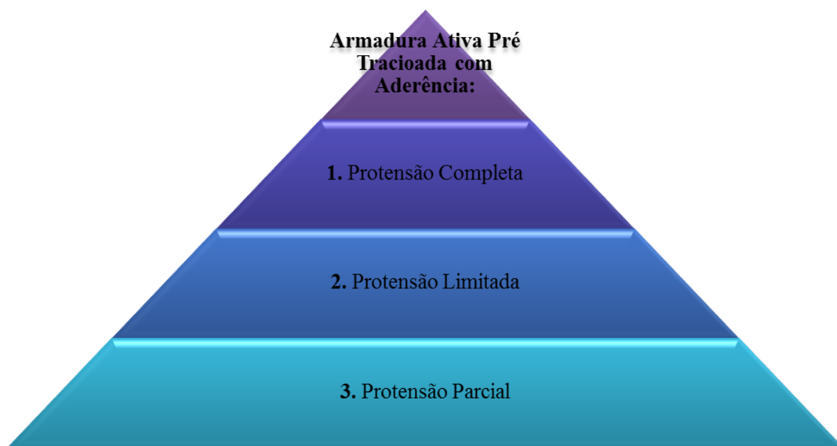
Figura 3 – Armadura Ativa Pré Tracionada: Classificação Fonte: Autor, 2016.
