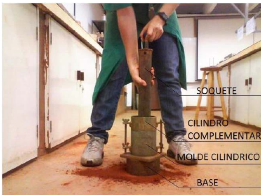
Figura 18 - Moldagem do corpo de prova para o Ensaio Proctor
