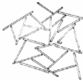
Figura 5 - Estrutura em "Castelo de cartas"
