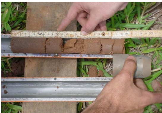
Figura 9 - Amostrador-padrão com maciço de solo.
