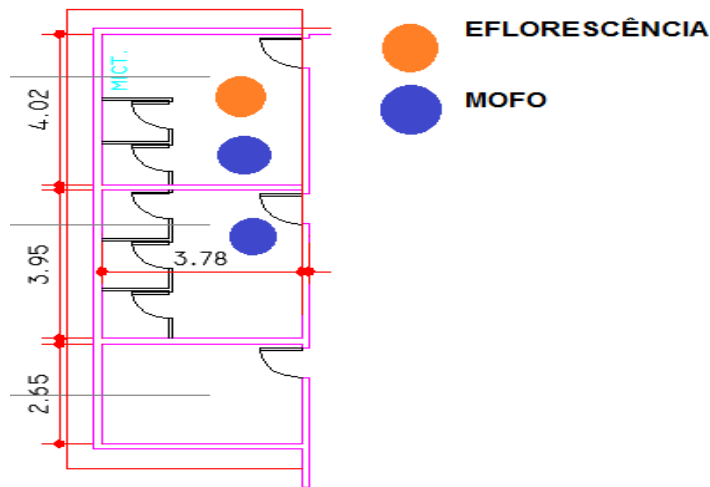
Figura 40 – Distribuição das patologias no bloco 7
