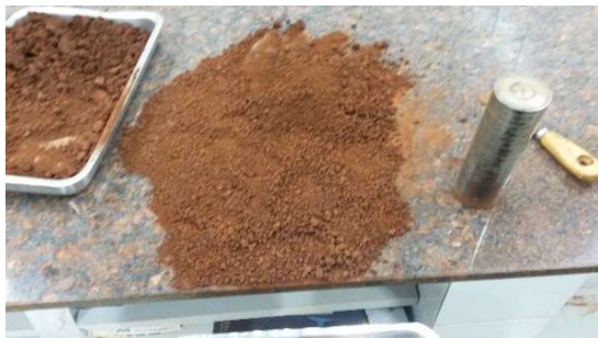
Figura 12 – Destorroamento do solo com adição de cimento
