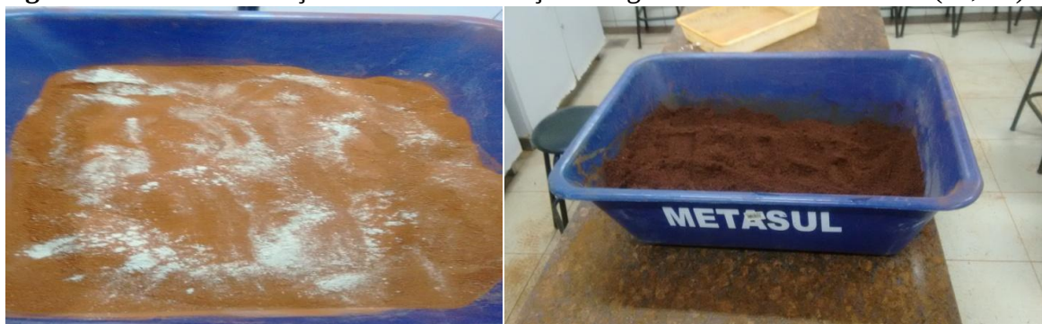
Figura 15 - Solo com adição de cimento e adição de água na sua umidade ótima (31,5%).
