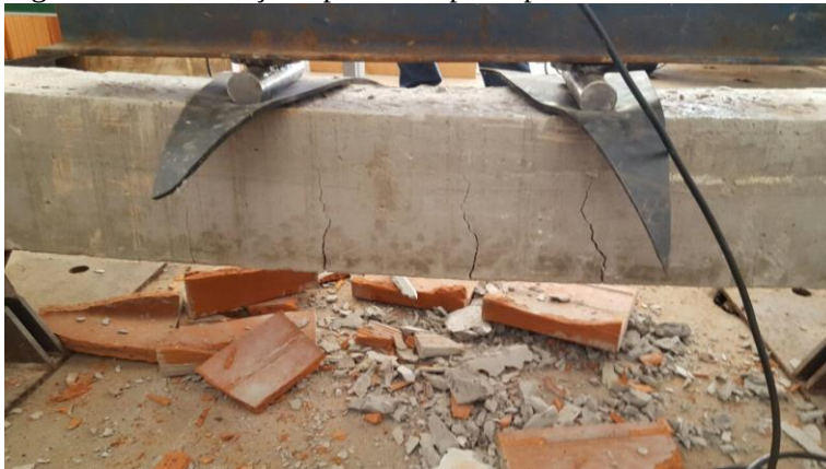
Figura 27 – Fissuração típica de ruptura por flexão – Método 1.
