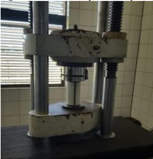
Figura 17 – Ensaio compressão corpo de prova.
