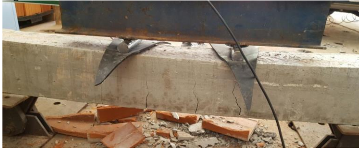
Figura 20 – Fissuras nas amostras.
