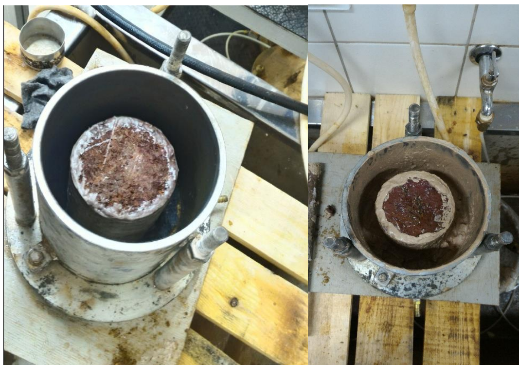
Figura 3.6 – Corpo de prova posicionado no centro do Permeâmetro.
