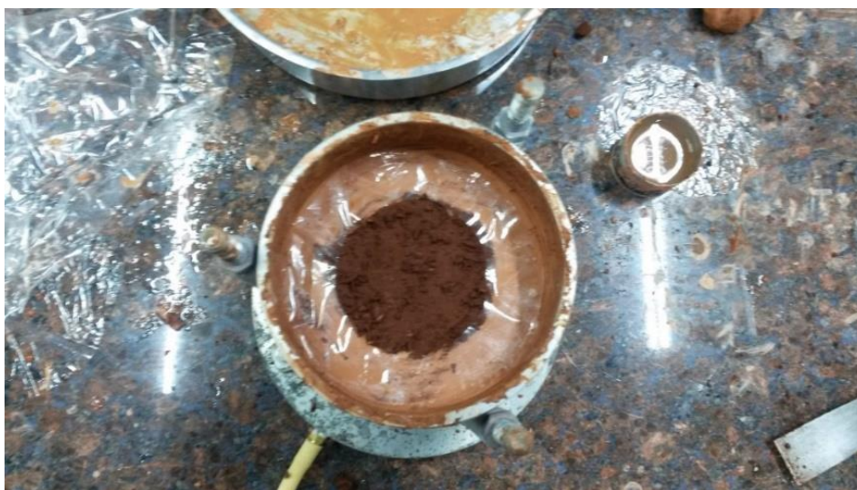
Figura 3.7 – Corpo de prova isolado pela argila bentonita.
