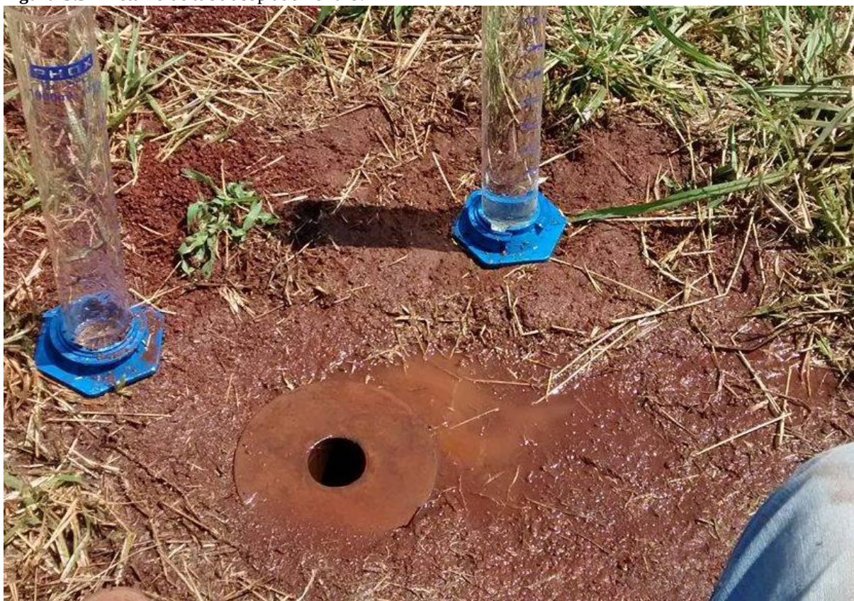
Figura 3.3 – Detalhe do tubo acoplado no furo.
