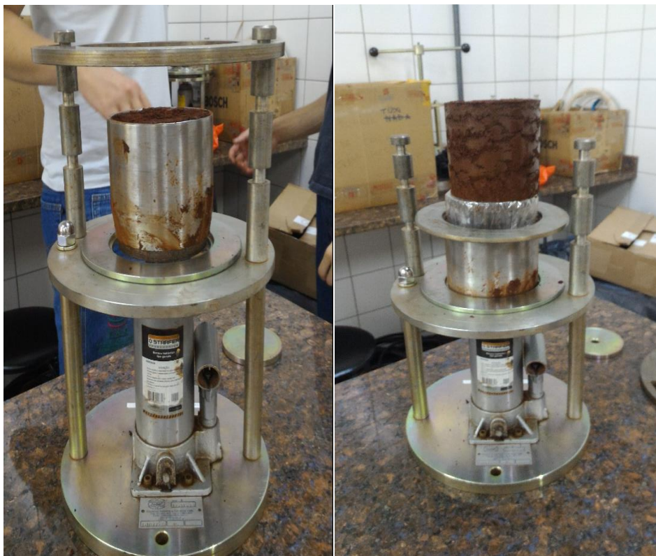
Figura 3.3 – Esquema montado para extração da amostra
