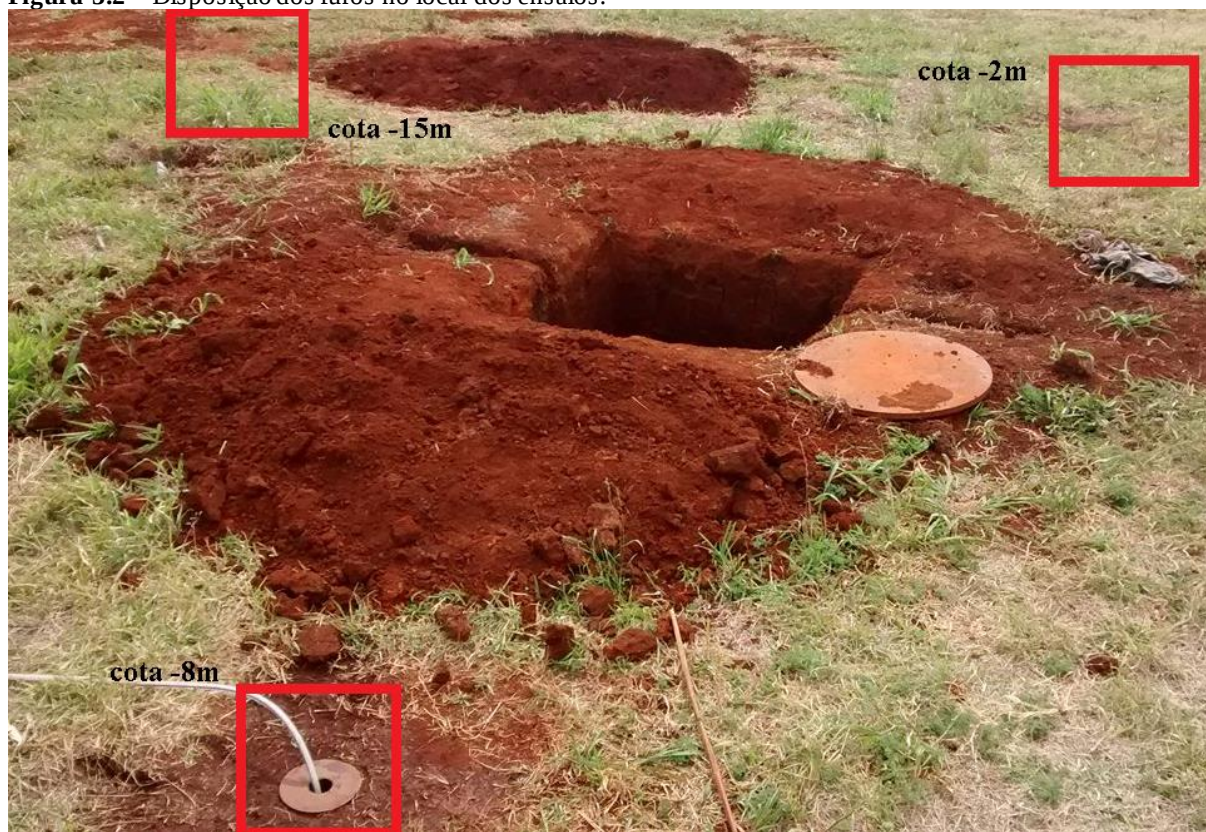
Figura 3.2 – Disposição dos furos no local dos ensaios.
