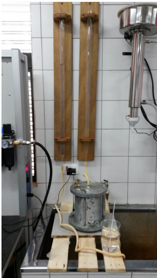
Figura 3.9 – Permeâmetro em funcionamento.
