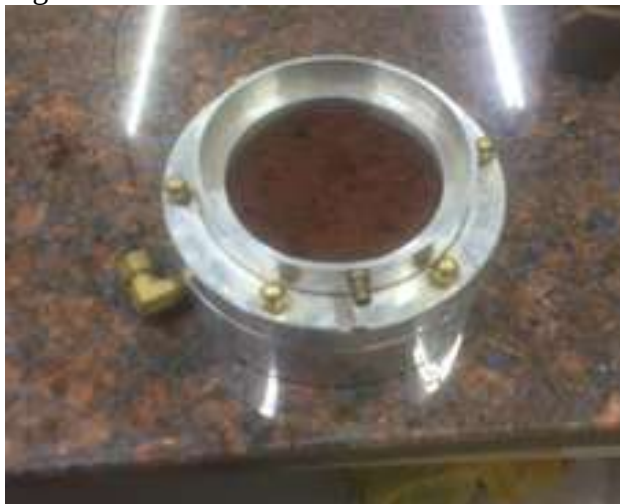
Figura 16 – Solo confinado na célula de adensamento
