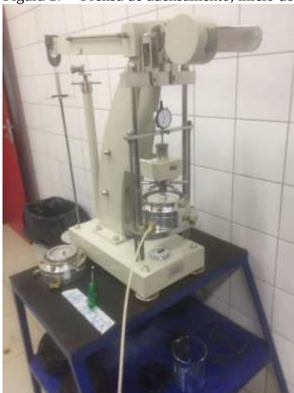
Figura 17 – Prensa de adensamento, início do ensaio com inundação do C.P.
