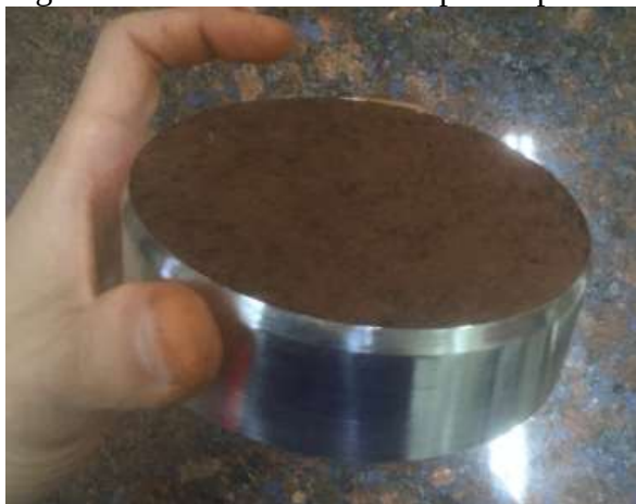
Figura 35 – Anel com amostra pronta para ensaio
