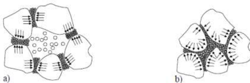
Figura 2 – Estrutura do solo colapsível: (a) antes da inundação e (b) após a inundação
