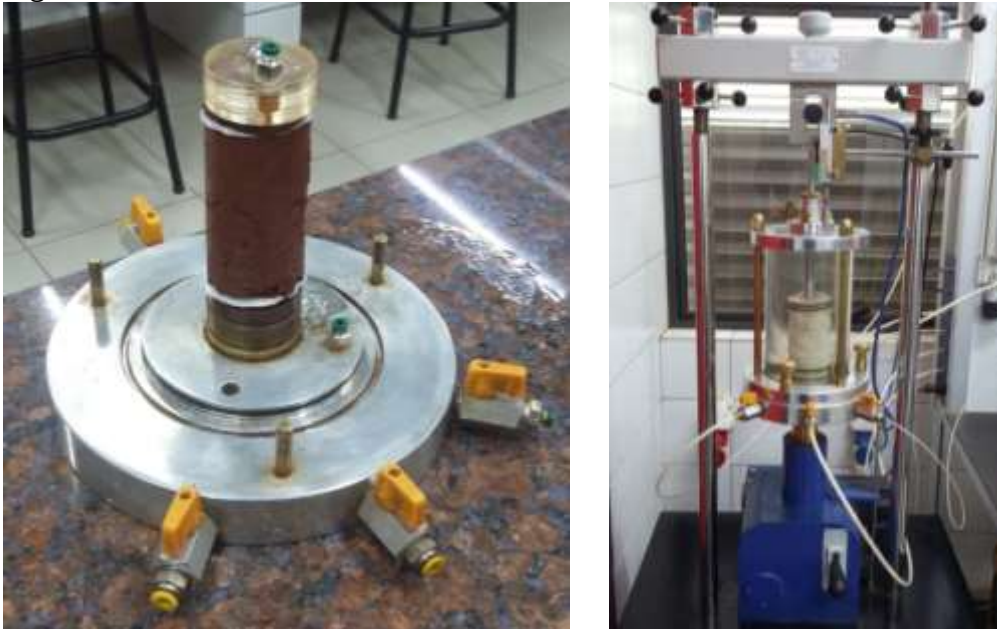
Figura 14: Prensa Triaxial com a câmara de ensaio triaxial
