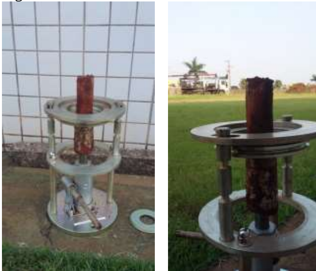
Figura 12: retirada de amostra indeformada do molde metálico
