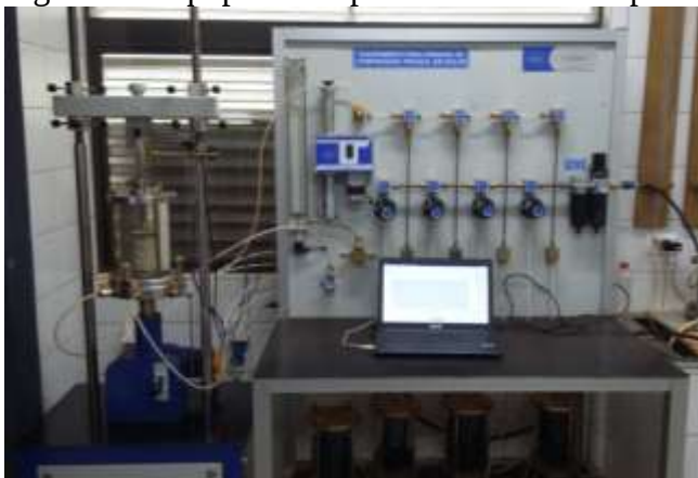
Figura 13: Equipamento para ensaios de compressão triaxial em solos
