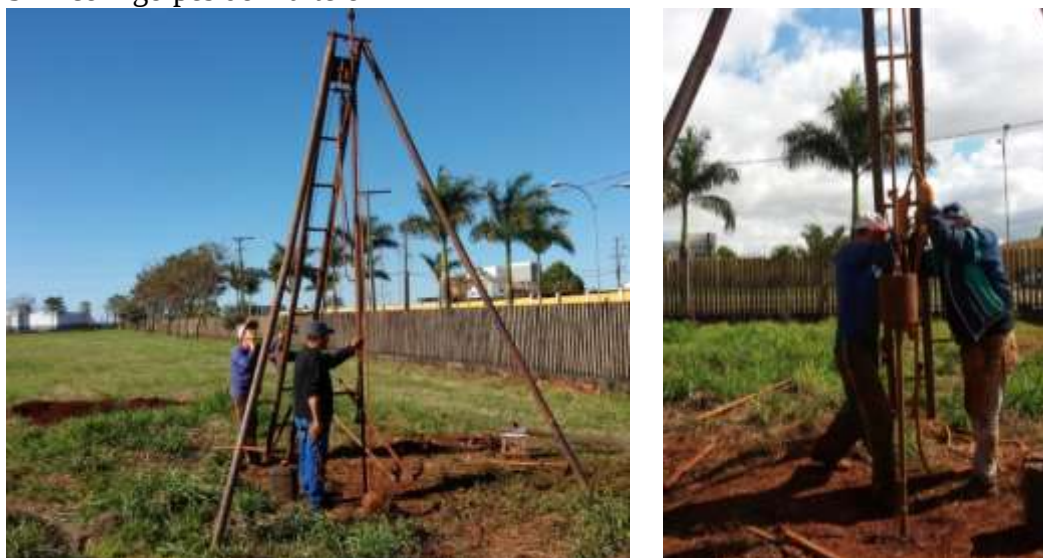
Figura 9: Montagem do equipamento de sondagem no ponto locado e sequência do ensaio SPT com golpes do martelo
