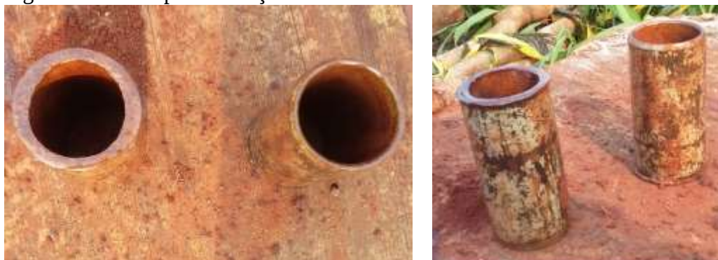
Figura 11: molde para cravação e retirada de amostras indeformadas
