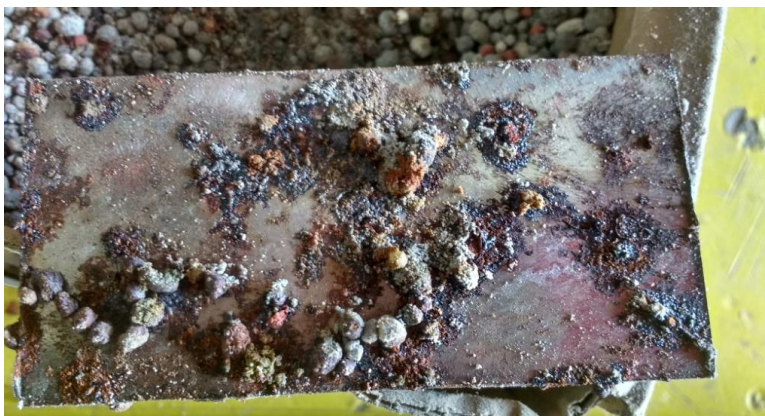
Figura 23 - Corpo de prova Fert-up, antes do processo de limpeza
