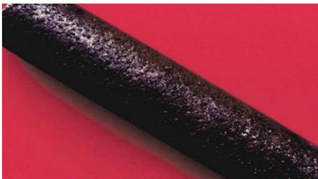
Figura 3 - Pites em tubo de aço carbono
