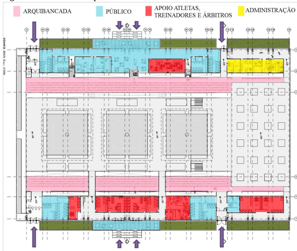
Figura 13 – Planta baixa pavimento térreo.
