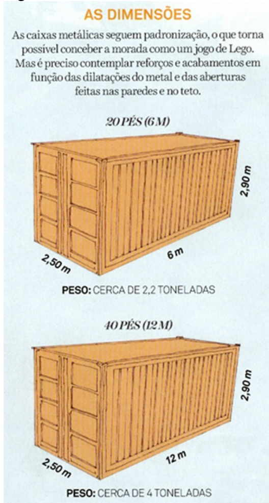
Figura 01: Dimensões dos containers.
