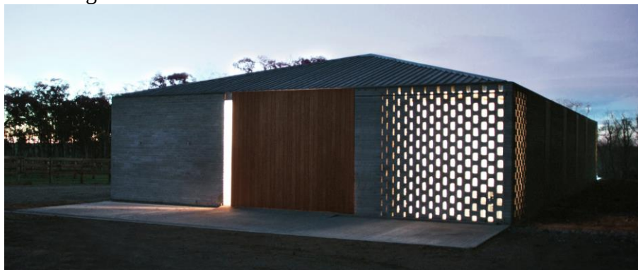
Figura 13: Elementos vazados da obra La Solana Stable.
