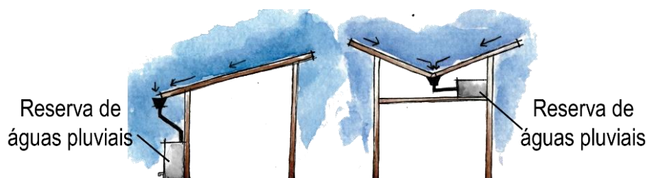
Figura 16 Modelo de cisternas sem bombeamento
