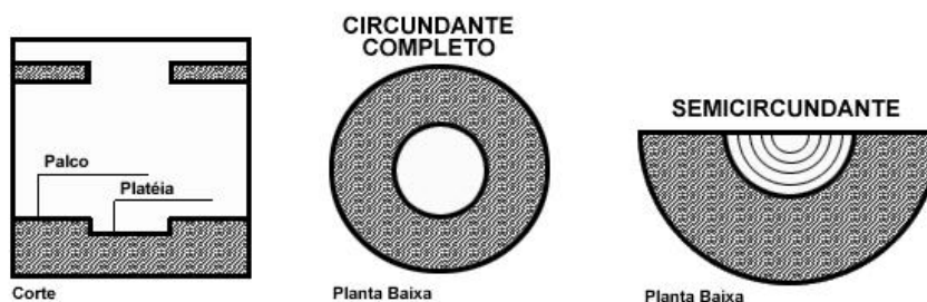
Figura 7 - Configuração de palco e plateia do tipo Circundante
