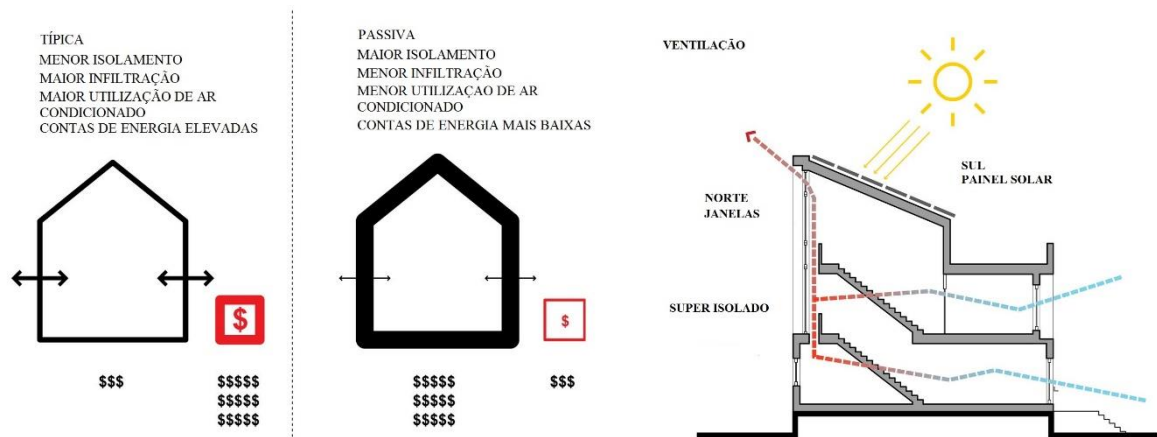
Figura 18: Diagrama e Sistema de Ventilação E+ Fonte: BRANT, 2015 (Modificado pela autora, 2017).
