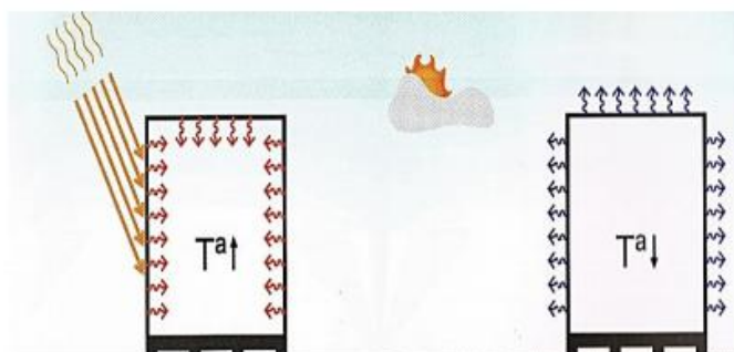
Figura 01: Aquecimento rápido durante o dia do container com a radiação solar e resfriamento rápido durante a noite
