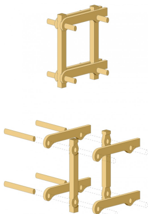
Figura 23 - Edifício Tamedia montagem estrutura
