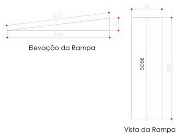
Figura 09: Planta Baixa e elevação da rampa
