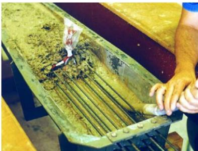
Figura 5: Preenchimento de uma fôrma metálica com concreto aderente à armadura
